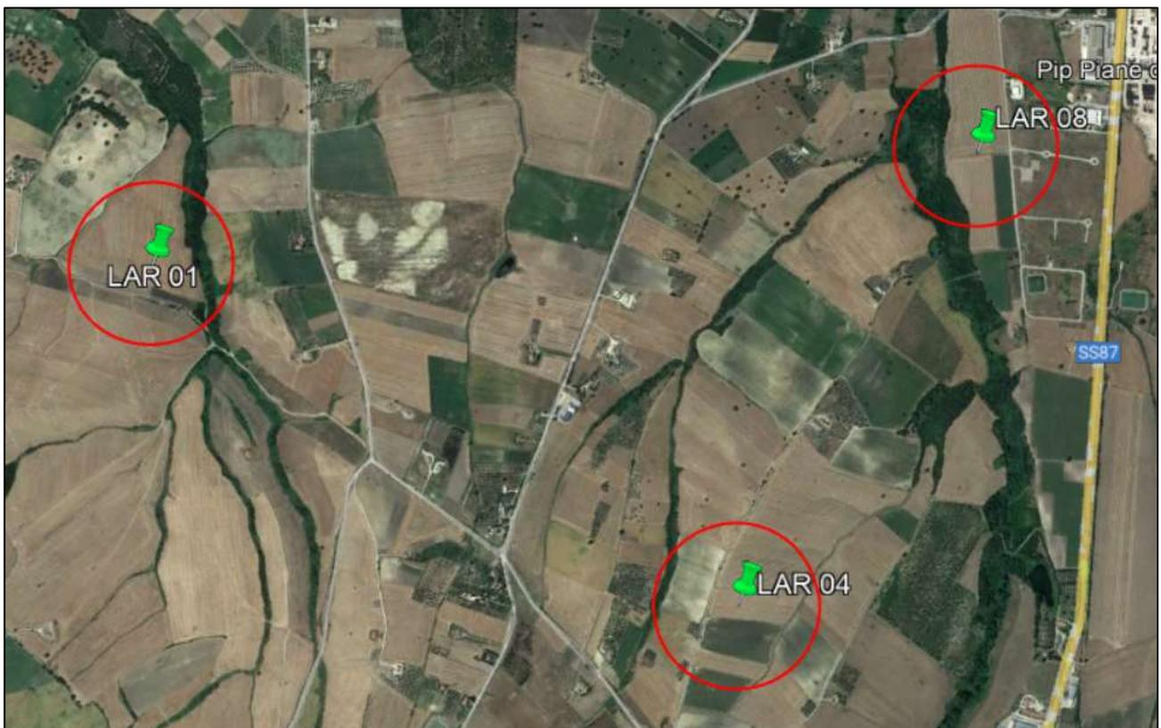
**Figura 8.2:** Aree interessata dalla rottura della pala relativamente agli aerogeneratori LAR 01, LAR 08 e LAR 04
