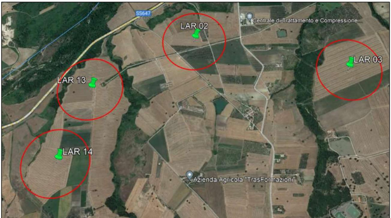
**Figura 8.1:** Aree interessata dalla rottura della pala relativamente agli aerogeneratori LAR 14, LAR 13, LAR 02 e LAR 03
