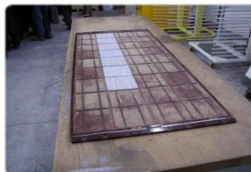
**Figura 2: Struttura di protezione dei moduli fotovoltaici**
