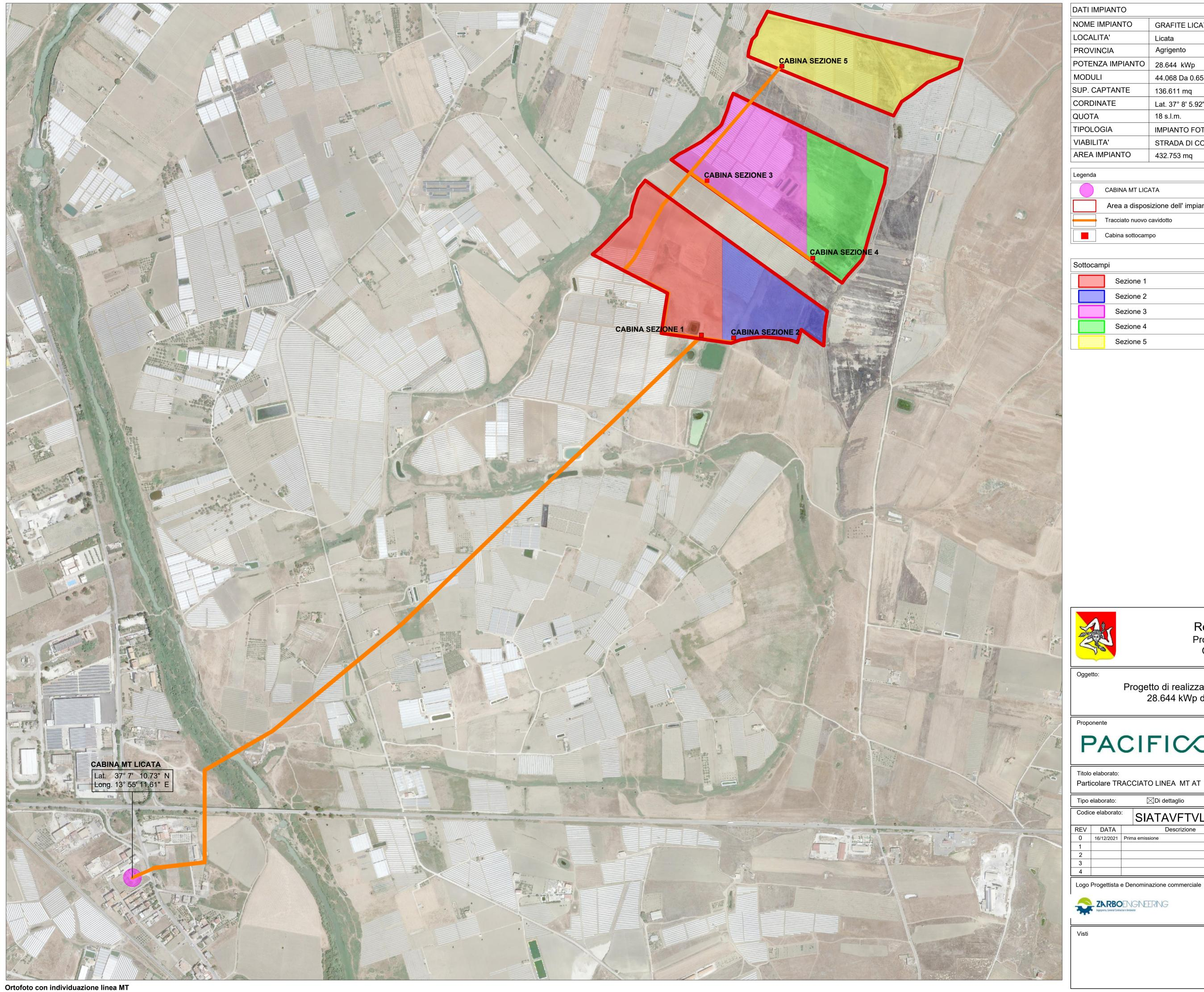
DATI IMPIANTO NOME IMPIANTO GRAFITE LICATA LOCALITA' Licata PROVINCIA Agrigento POTENZA IMPIANTO 28.644 kWp 44.068 Da 0.65 kWp SUP. CAPTANTE 136.611 mq CORDINATE Lat. 37° 8' 5.92" N ; Long. 13° 56' 20.08" E 18 s.l.m. TIPOLOGIA IMPIANTO FOTOVOLTAICO A INSEGUIMENTO MONOASSIALE VIABILITA' STRADA DI COLLEGAMENTO AREA IMPIANTO 432.753 mq CABINA MT LICATA Area a disposizione dell' impianto LICATA Tracciato nuovo cavidotto Cabina sottocampo Lunghezza cavidotto Sottocampi
