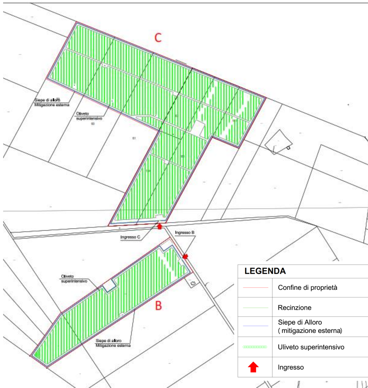
Figura 2-3: Impianto agro-fotovoltaico blocco "B" e "C"- aree destinate all'agricoltura e misure mitigative
