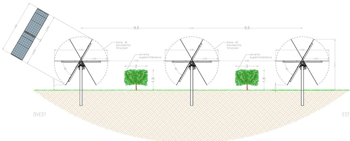
Figura 1-4: Schema d’impianto dell’ulivo super intensivo tra i pannelli fotovoltaico – vista in sezione
