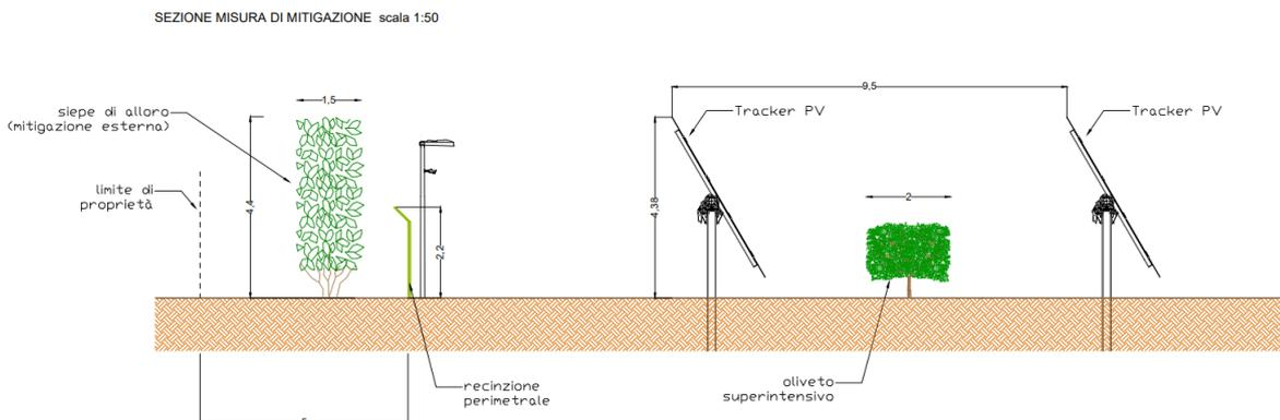
Figura 1-2: Layout misura mitigativa dell'impianto agro-fotovoltaico
