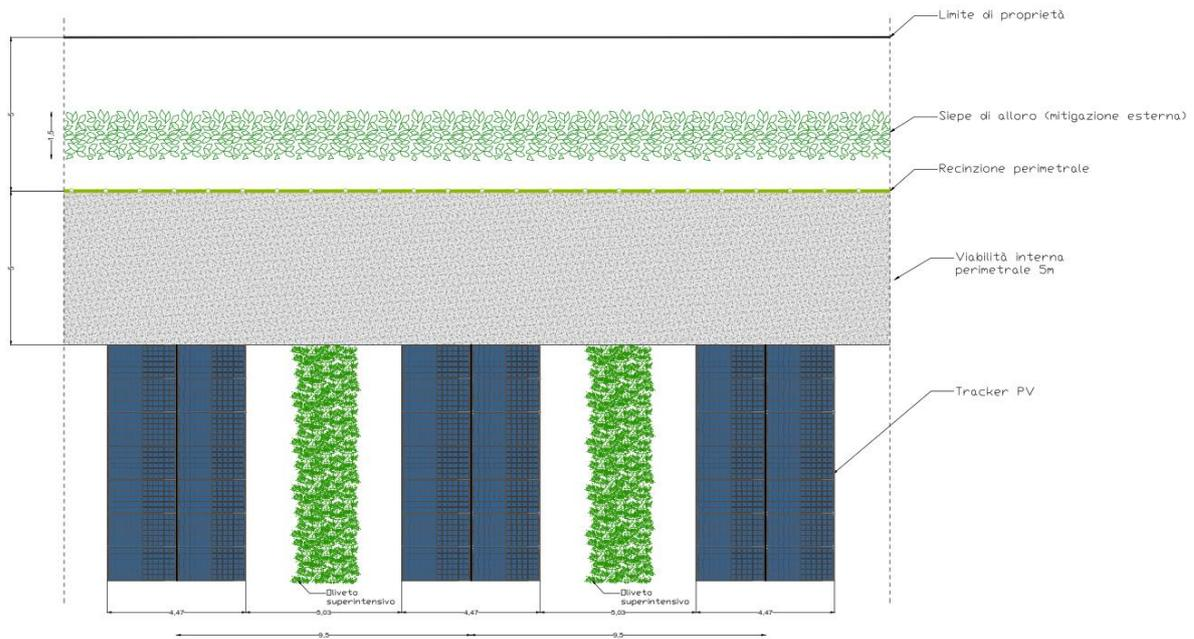
**Figura 4-3:** Schema esempio d’impianto uliveto super intensivo tra i pannelli fotovoltaici
