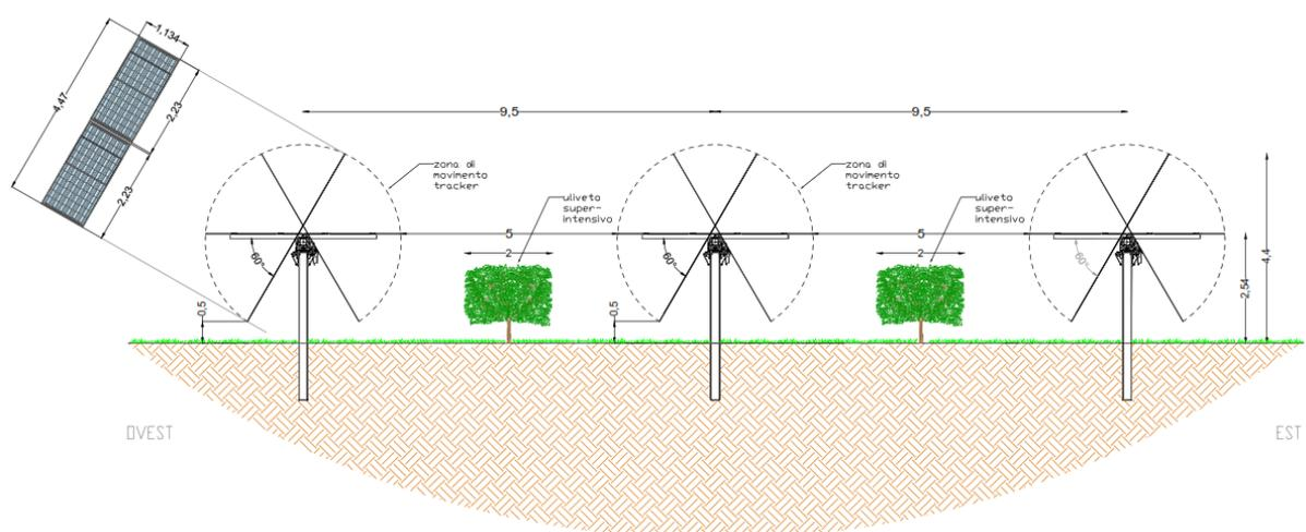
Figura 2-13: Schema impianto tracker nel sistema Agro-fotovoltaico
