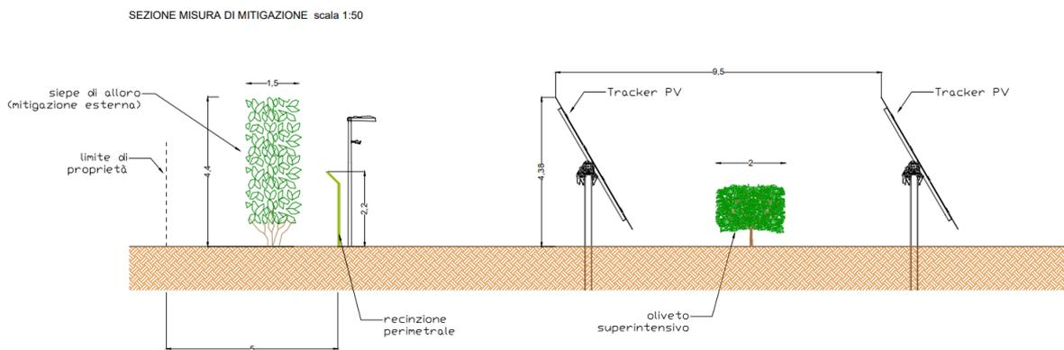
Figura 4-2: Layout misura mitigativa dell'impianto agro-fotovoltaico
