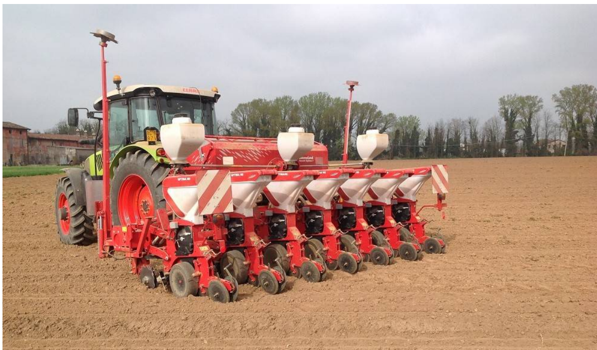
Foto n.8. Tipologia seminatrice di precisione da impiegarsi nella semina delle colture foraggere
