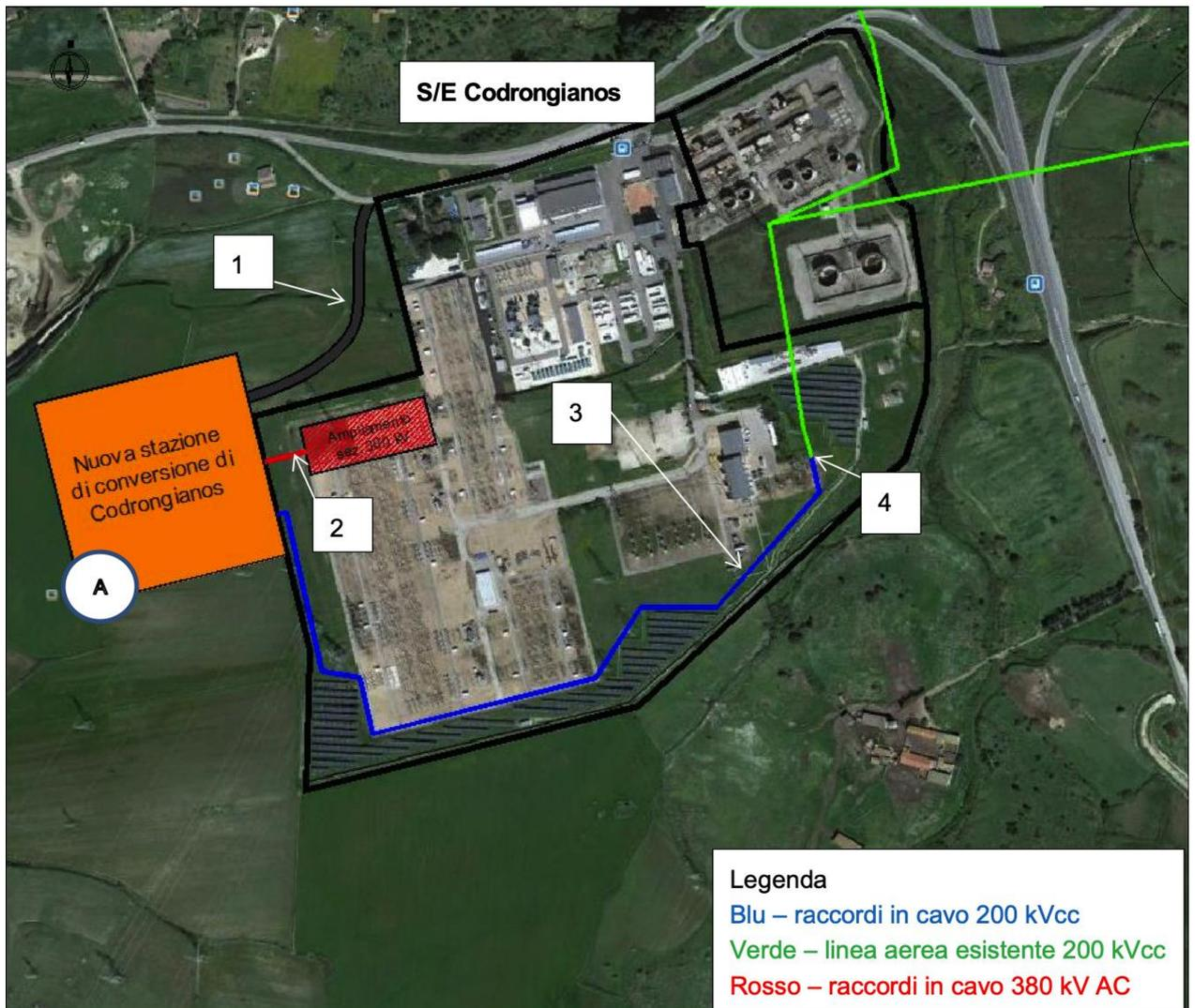
I lavori per la realizzazione della stazione di Conversione di Codrongianos avranno inizio con le opere di movimentazione terre per il livellamento dell'area destinata ad accogliere il nuovo impianto situato in adiacenza all'esistente impianto; essendo l'area d'intervento pressoché pianeggiante tali opere saranno di entità limitata.
