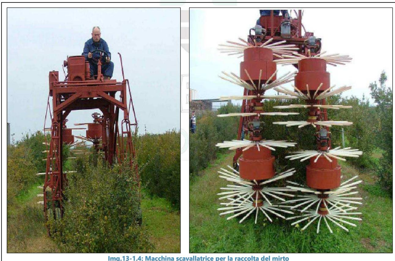
Img.13-1.4: Macchina scavallatrice per la raccolta del mirto
