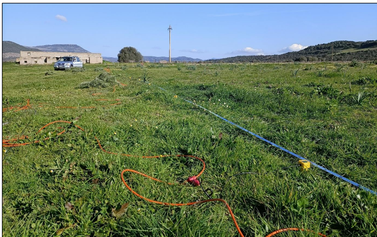
Figura 41 - Rilievo sismico MASW nell'area di studio.
