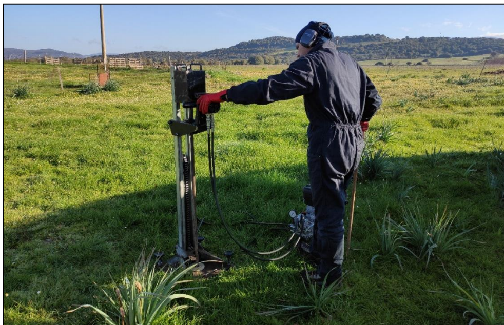
Figura 25 - Penetrometro mod. DM 30 – Deep Drill durante l'esecuzione della prova DIN 1.
