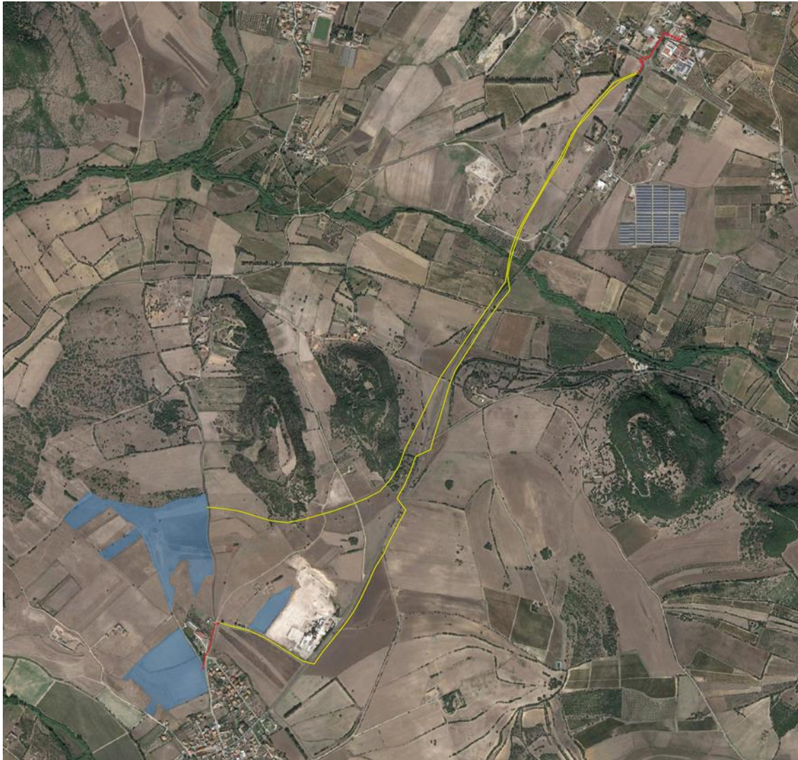
1: localizzazione dell'area di intervento con inserimento delle planimetrie dell'impianto (azzurro) e del percorso dei cavi (giallo, rosso).
