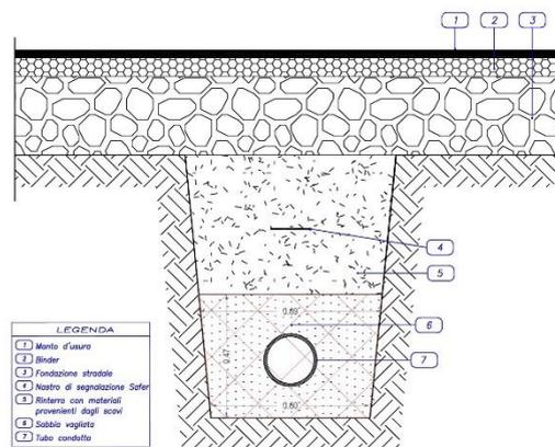
Scavo Posizionamento Cavidotto MT =  $1461 \text{ m} \times \text{Area sezione } 1,08 = 1577,88 \text{ m}^3$
