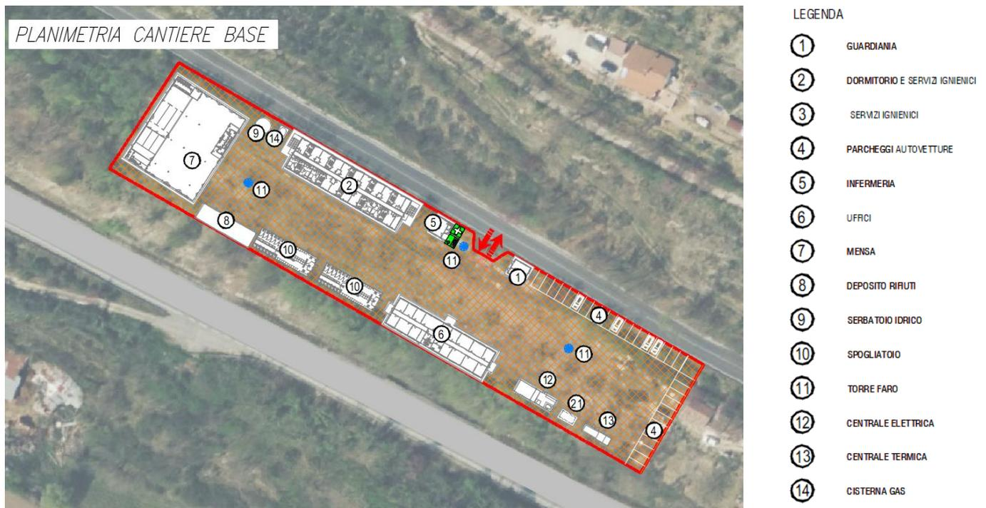
In termini di sicurezza, le problematiche legate alle "baracche di cantiere" sono di tipo strutturale e di fruibilità degli spazi, di conseguenza cubatura-superficie-altezza verranno nelle fasi successive di progettazione dimensionate nel dettaglio in funzione del numero massimo di utenti previsti:
