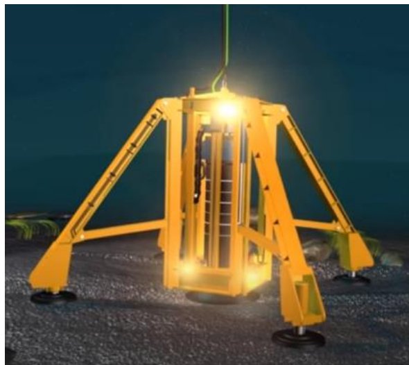
Figura 5-7 – Esempio di palo infisso nel fondale marino
