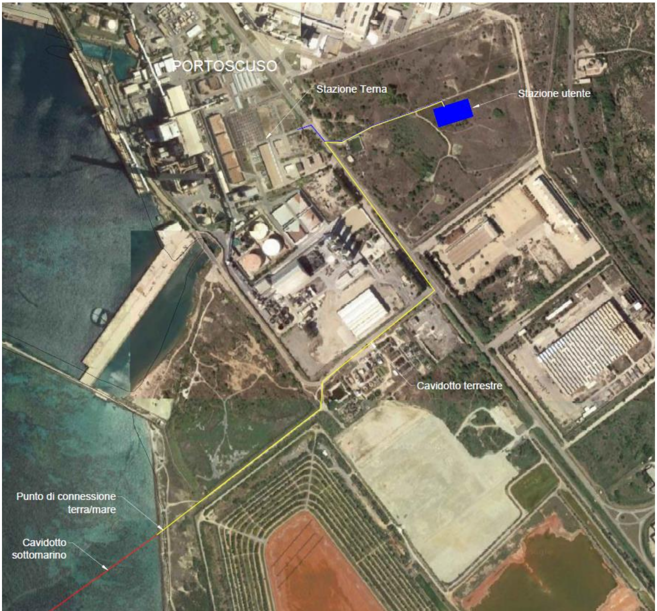
Figura 3.5 – Percorso terrestre dei cavi su ortofoto
