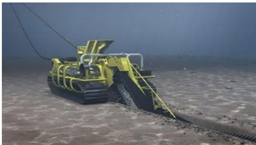
Figura 5-15 – Sistemi protezione dei cavi per interrimento
