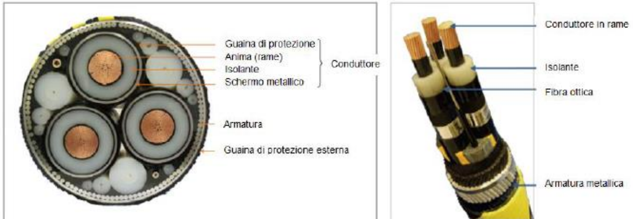
Figura 5-12 – Esempio di cavo di connessione
