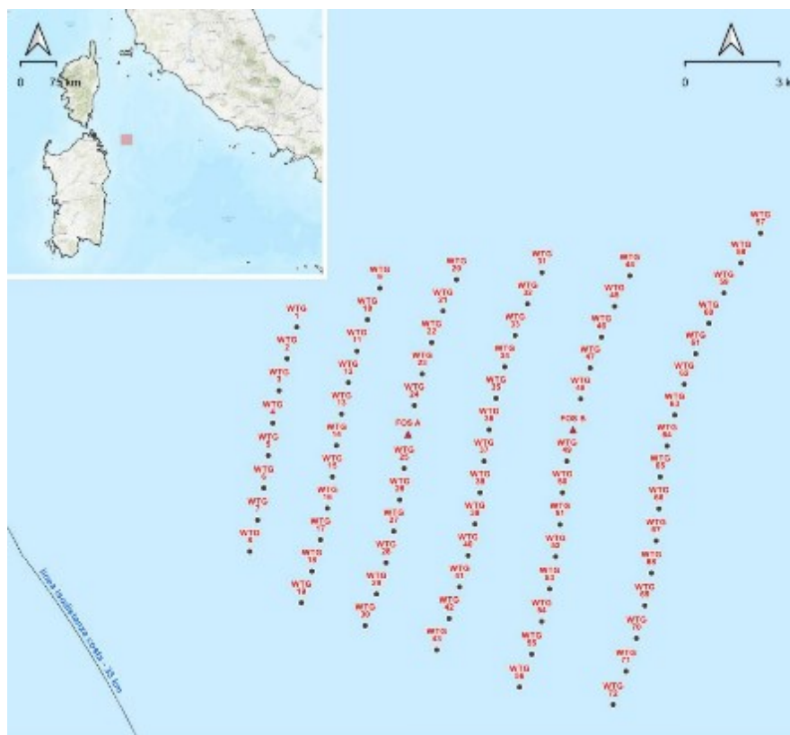
Figura 2: Ubicazione e layout di impianto
