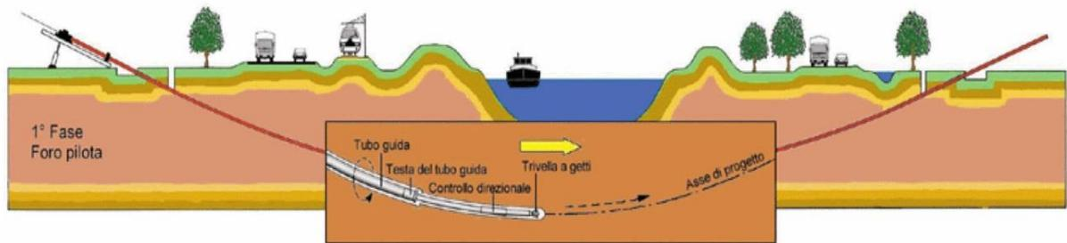
**FIG 2 Schema della fase di realizzazione del foro pilota**
