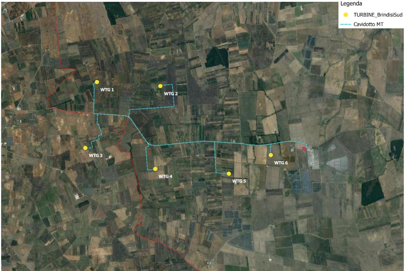
**Figura 2-4: Area di intervento: dettaglio layout di progetto su ortofoto**
