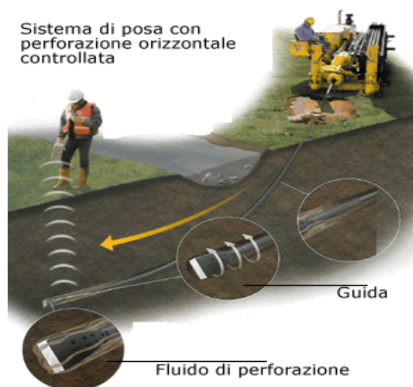
FIG 8 Sistema di trivellazione orizzontale controllata (T.O.C.).
