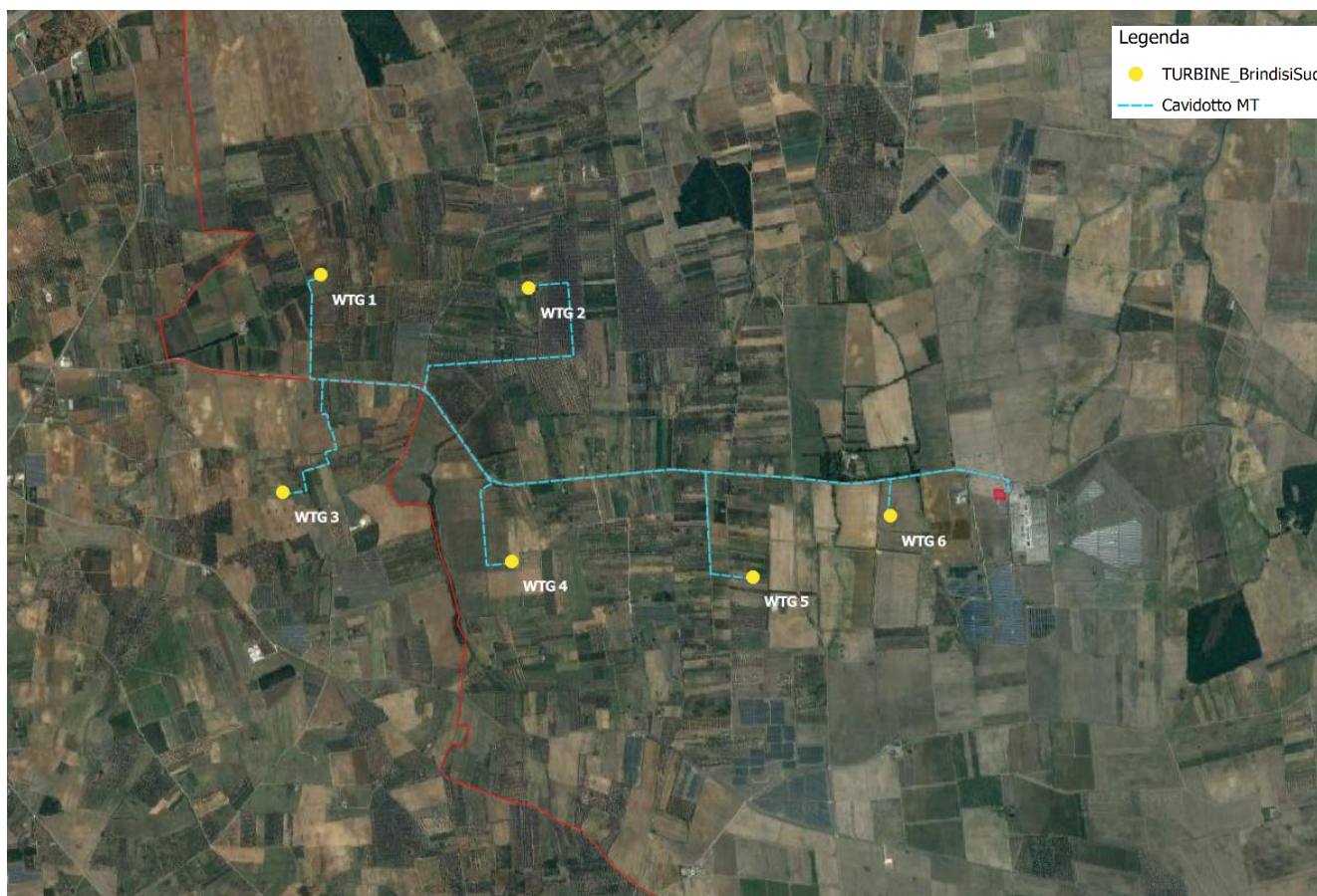
Figura 4-4: Area di intervento: dettaglio layout di progetto su ortofoto
