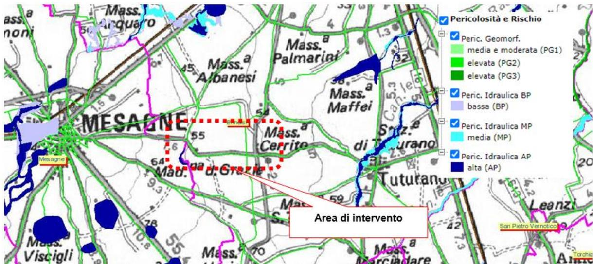
FIG 1 Sovrapposizione con aree a pericolosità idraulica e geomorfologica su IGM
