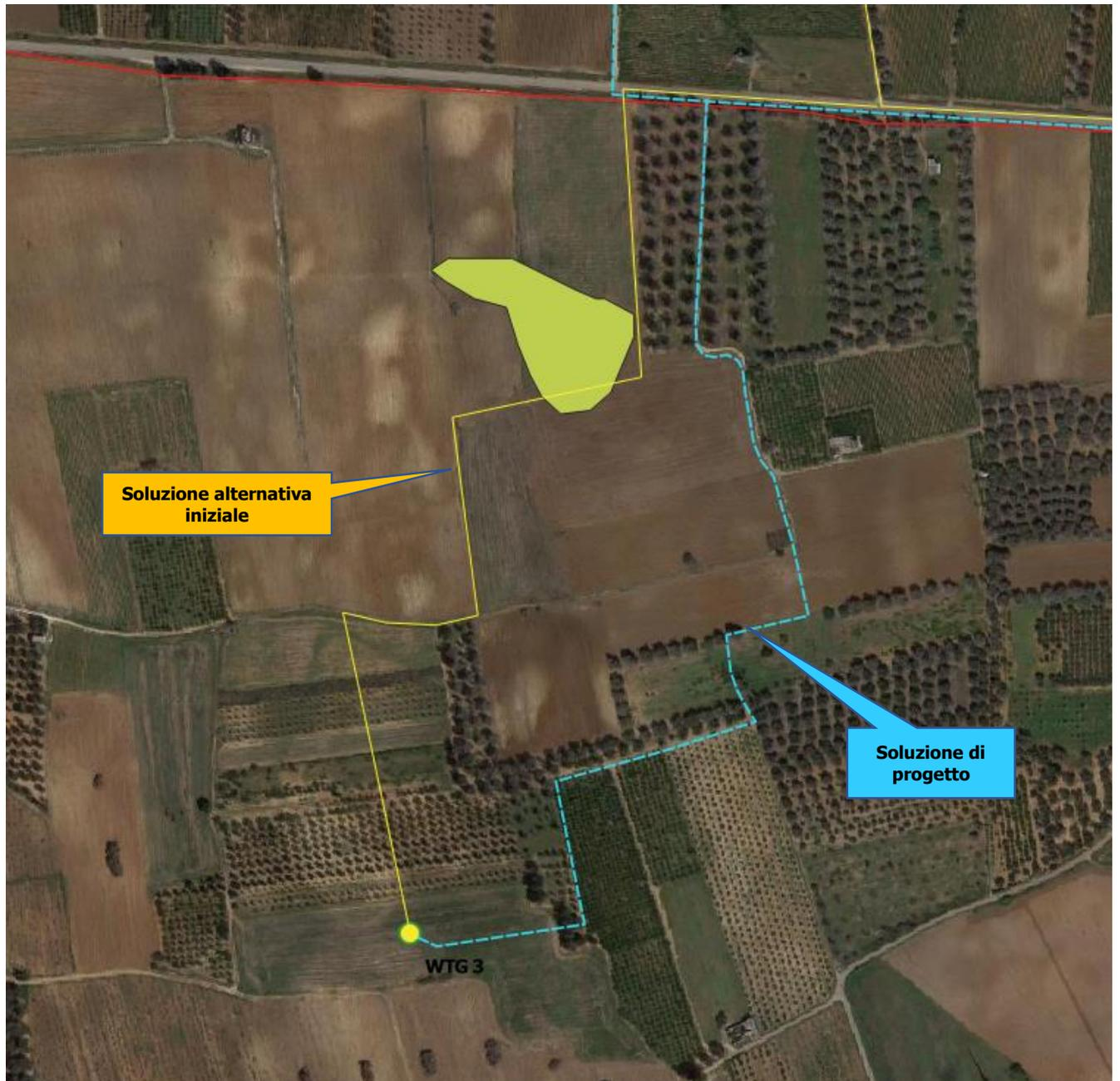
**Figura 3-7: Analisi alternative percorso cavidotto relativo alla WTG03**
