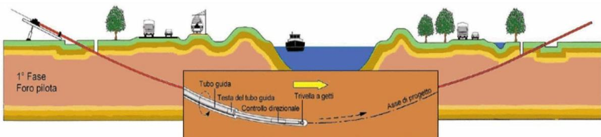
**FIG 5 Schema della fase di realizzazione del foro pilota**
