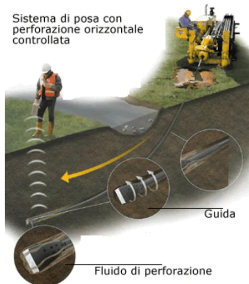
**FIG 4 Sistema di trivellazione orizzontale controllata (T.O.C.).**
