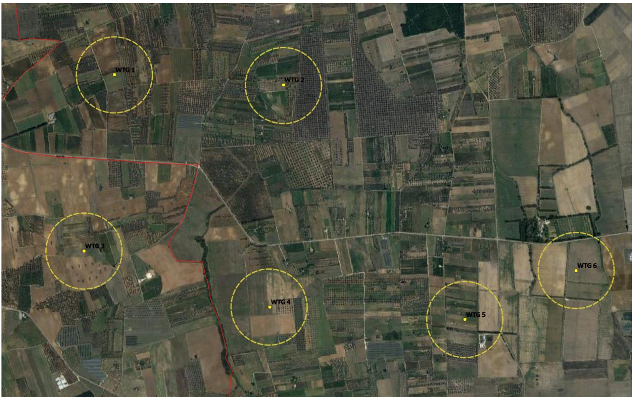
Figura 1 – Indicazione della gittata massima della pala in caso di distacco
