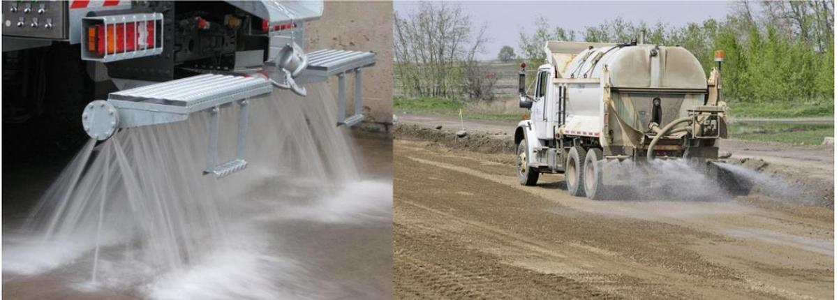
**Figura 8-1: Automezzo per la bagnatura delle piste sterrate**
