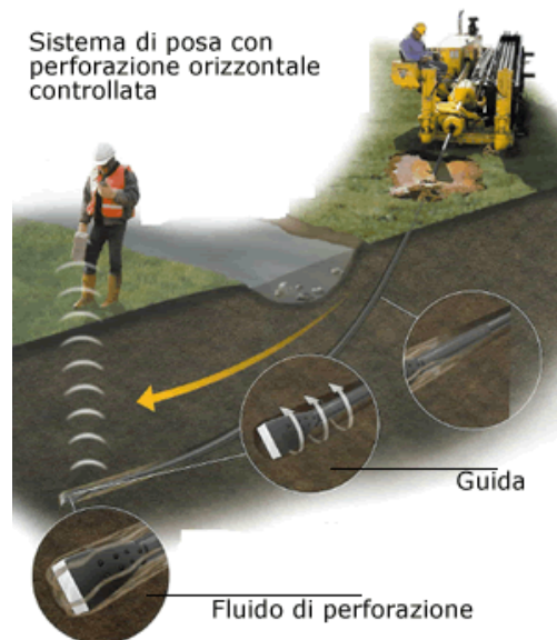
FIG 2 Sistema di trivellazione orizzontale controllata (T.O.C.).
