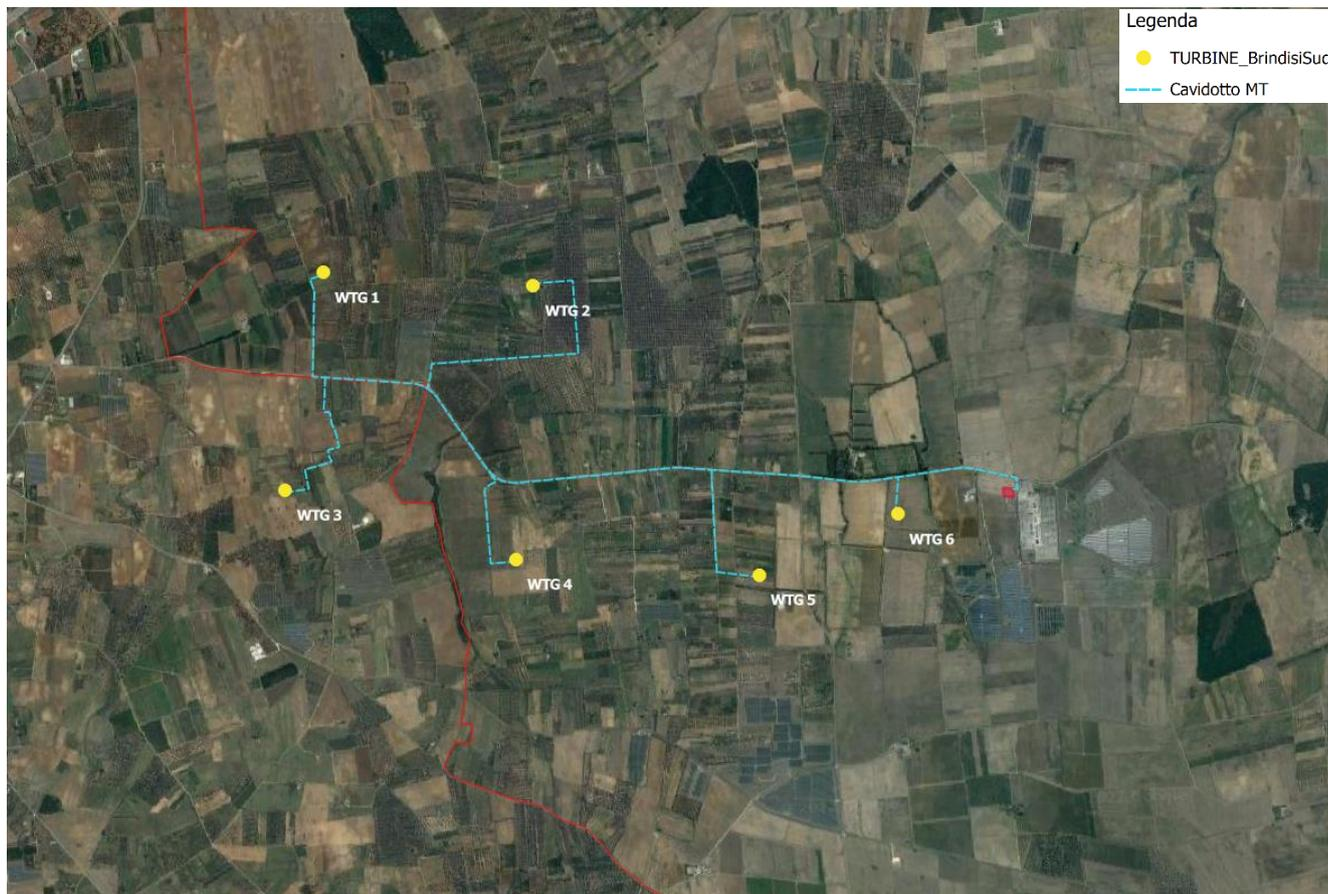
**Figura 3-3: Area di intervento: dettaglio layout di progetto su ortofoto**
