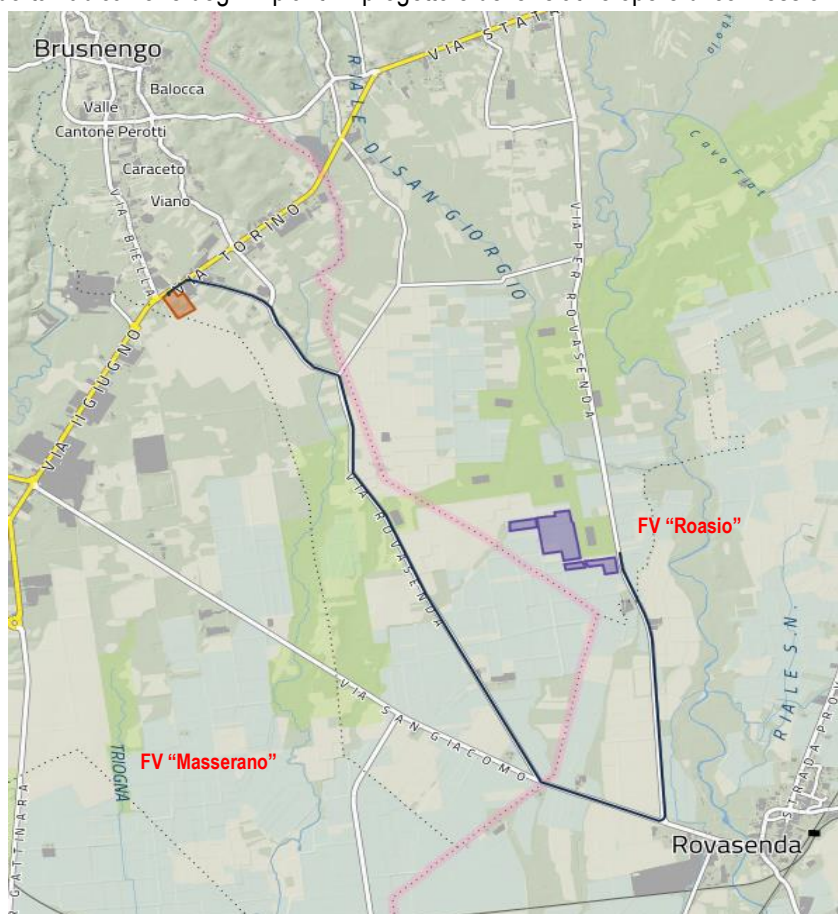
Figura 2.1 - Inquadramento delle opere in progetto; in viola l'impianto fotovoltaico (limite recinzione esterna), in nero la linea di connessione interrata e in rosso l'impianto di utenza per la connessione alla rete esistente (fonte: www.geoportale.piemonte.it ).
