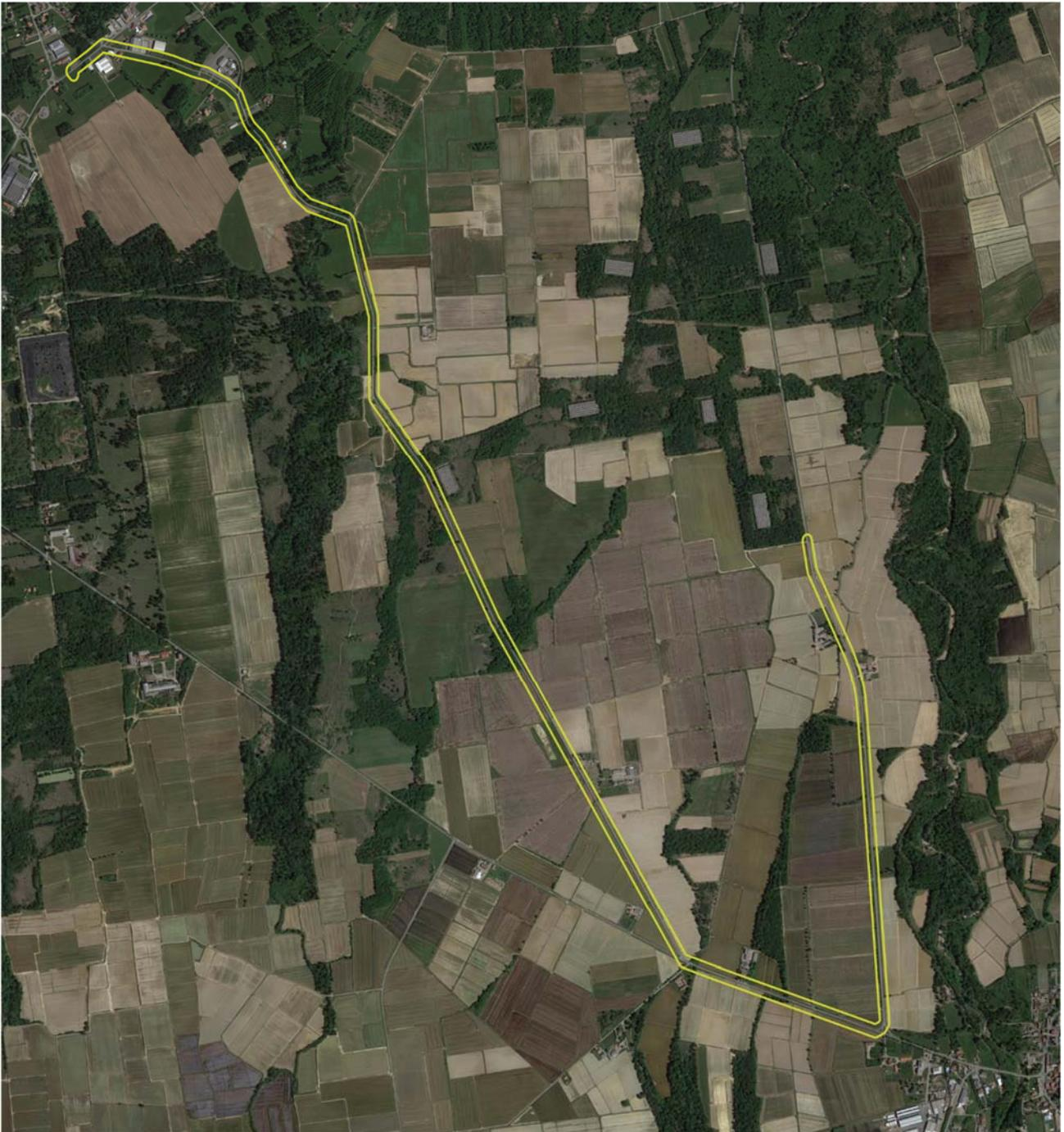
Tracciato linea AT interrata di collegamento dell'impianto alla cabina primaria; in giallo è riportata la zona buffer di 30 m
