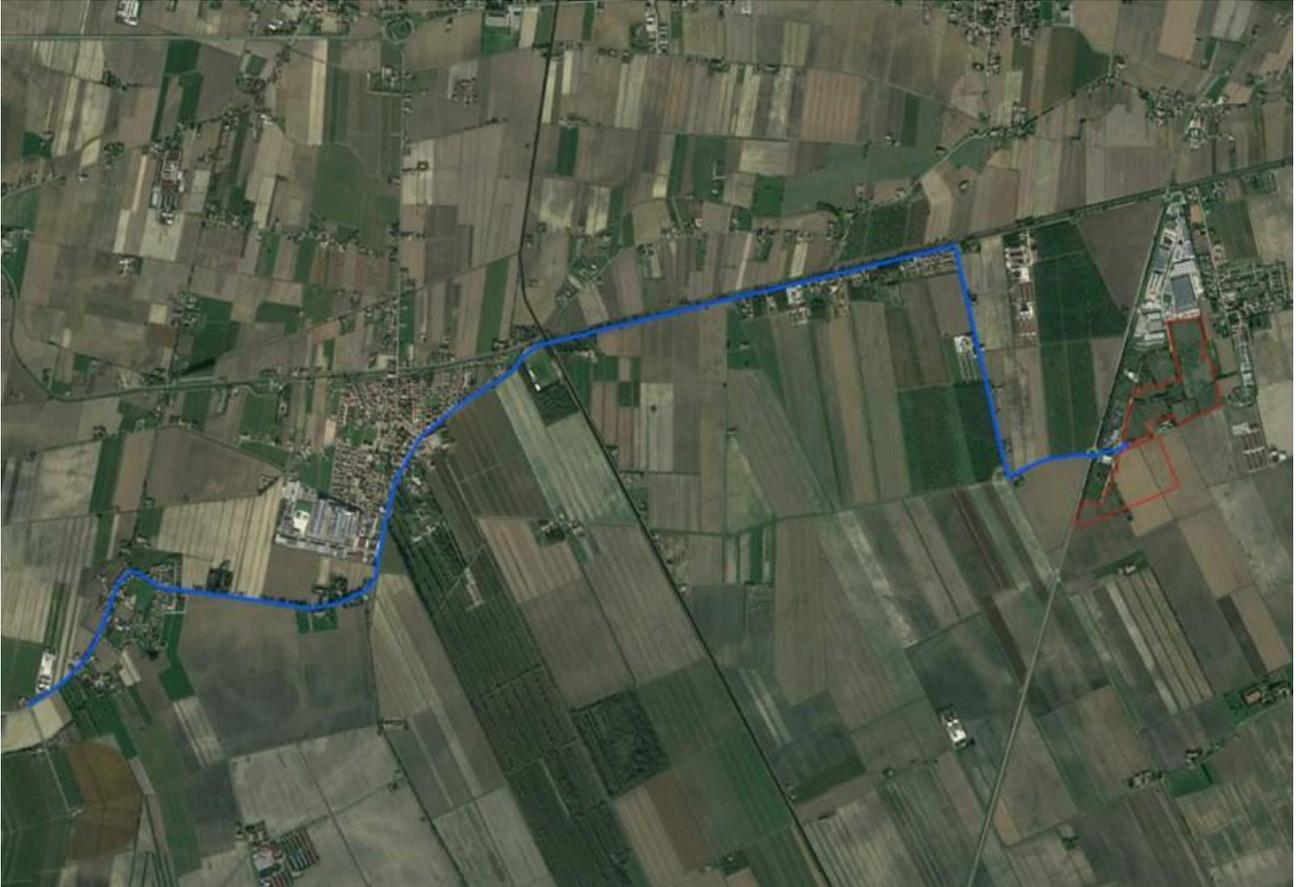
Figura 1-2 – Dettaglio foto aerea dell'area recintata del campo fotovoltaico (tratto rosso) e dell'elettrodotto (tratto blu)
