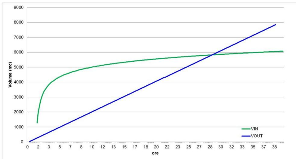
Figura 4-5 – Stato Post Operam Area SUD: volumi in ingresso e uscita per precipitazioni con TR 50 anni e u = 5 l/s ha
