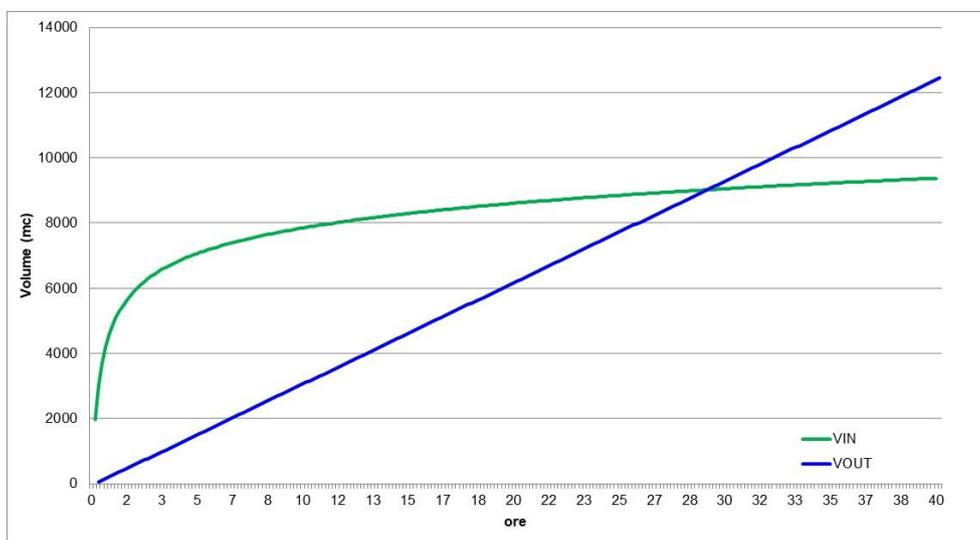
Figura 4-4 – Stato Post Operam Area NORD: volumi in ingresso e uscita per precipitazioni con TR 50 anni e u = 5 l/s ha
