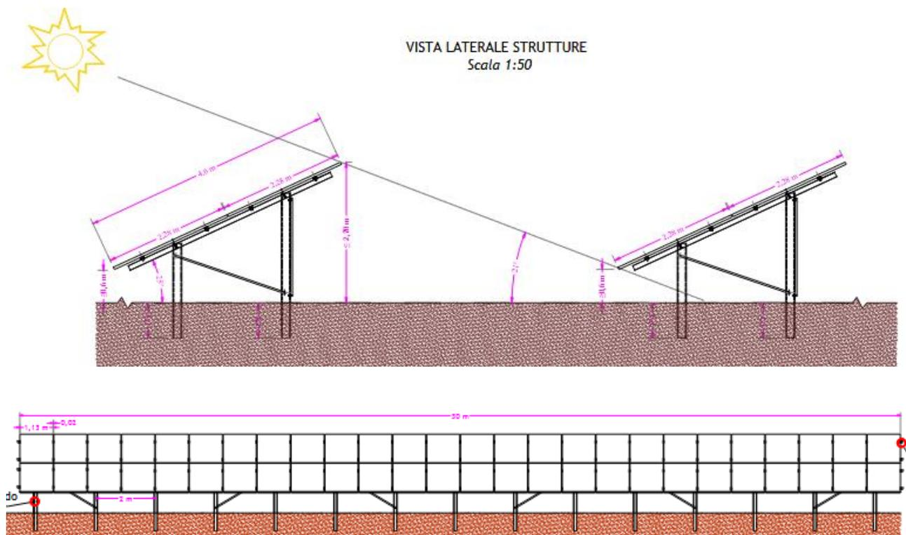
Figura 2-2 – Profilo delle file dei pannelli fotovoltaici
