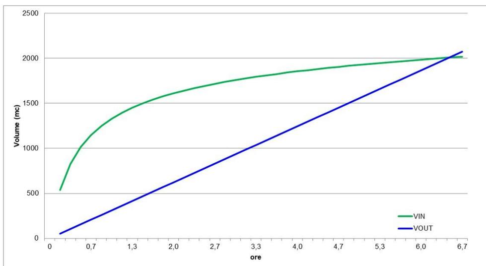
Figura 4-2 – Stato Ante Operam Area NORD: volumi in ingresso e uscita per precipitazioni con TR 50 anni e  $u = 5$  l/s ha
