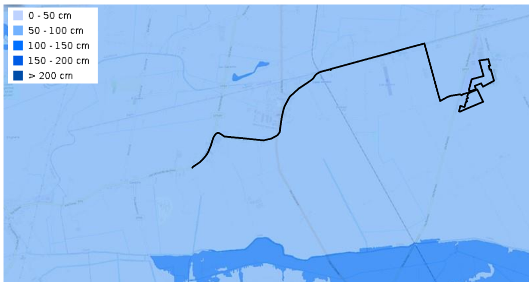
Figura 5-54 – Tirante per TR 300 anni (Fonte web gis SIGMA PGRA 2021/2027 – Autorità di Bacino delle Alpi Orientali)
