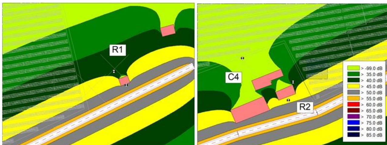
Figura 4-6 – Mappa grafica livelli di emissione del traffico indotto ad altezza 4m (Leq[dB(A)])
