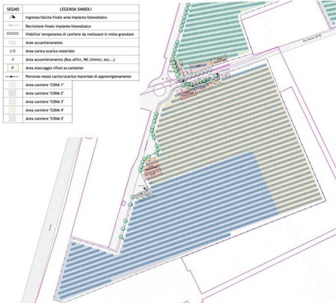
Figura 2-9 - Aree di cantiere impianto CONA 4-5
