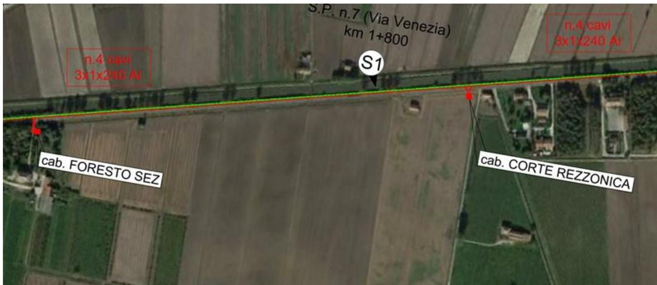
Figura 4-1 - Localizzazione delle due cabine oggetto di autorizzazione presso le sponde del canale
