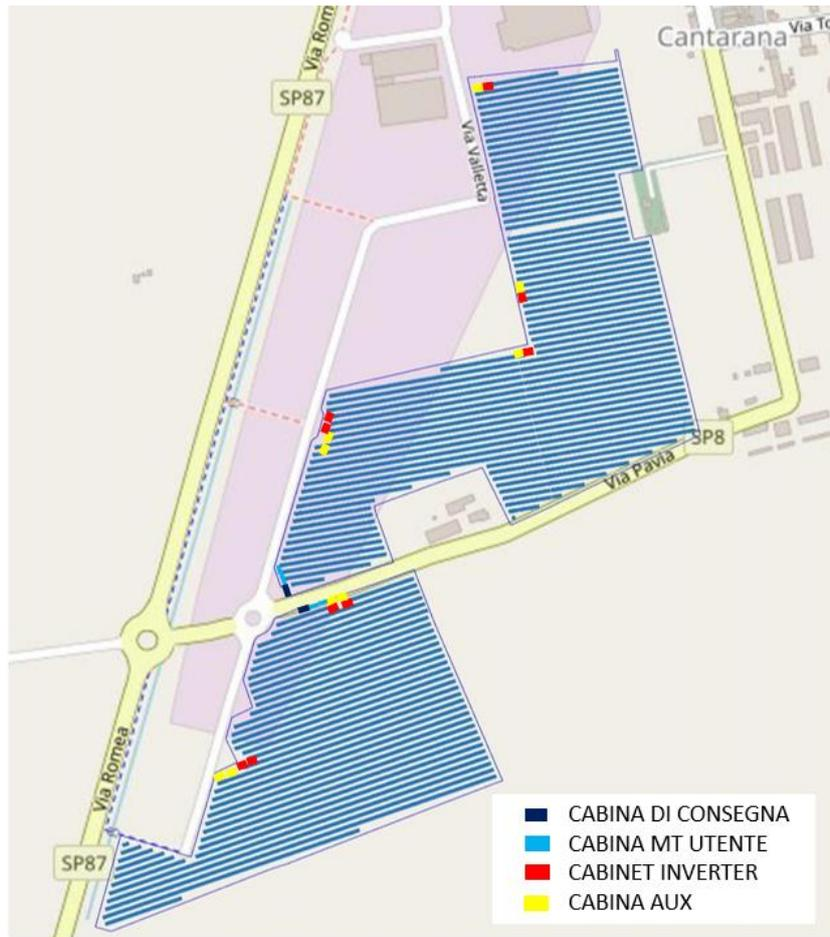
Figura 5-2 – Progetto impianto (Fonte: Relazione di progetto)
