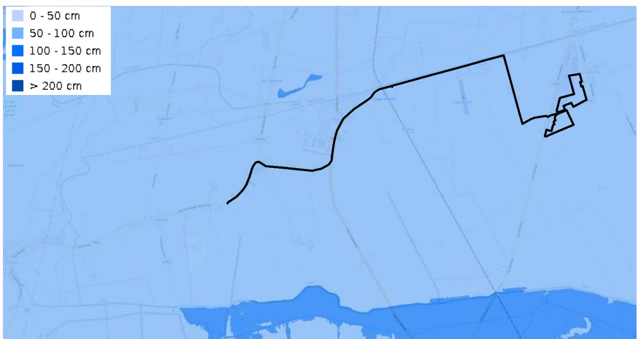
Figura 6-20 – Tirante per TR 100 anni (Fonte web gis SIGMA PGRA 2021/2027 – Autorità di Bacino delle Alpi Orientali)
