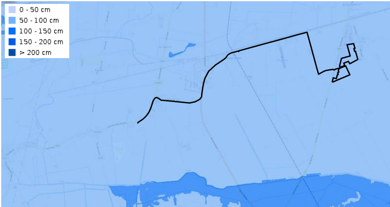
Figura 6-21 – Tirante per TR 300 anni (Fonte web gis SIGMA PGRA 2021/2027 – Autorità di Bacino delle Alpi Orientali)
