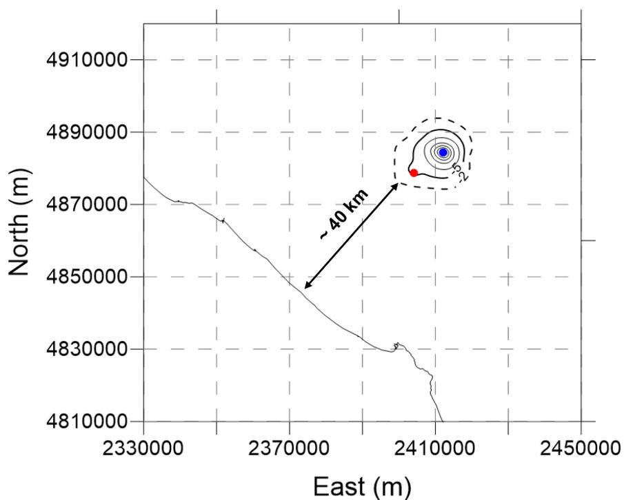
Figura 20 – Curve di iso-subsidenza per lo scenario SVIL\_M2 a fine simulazione (2062).
