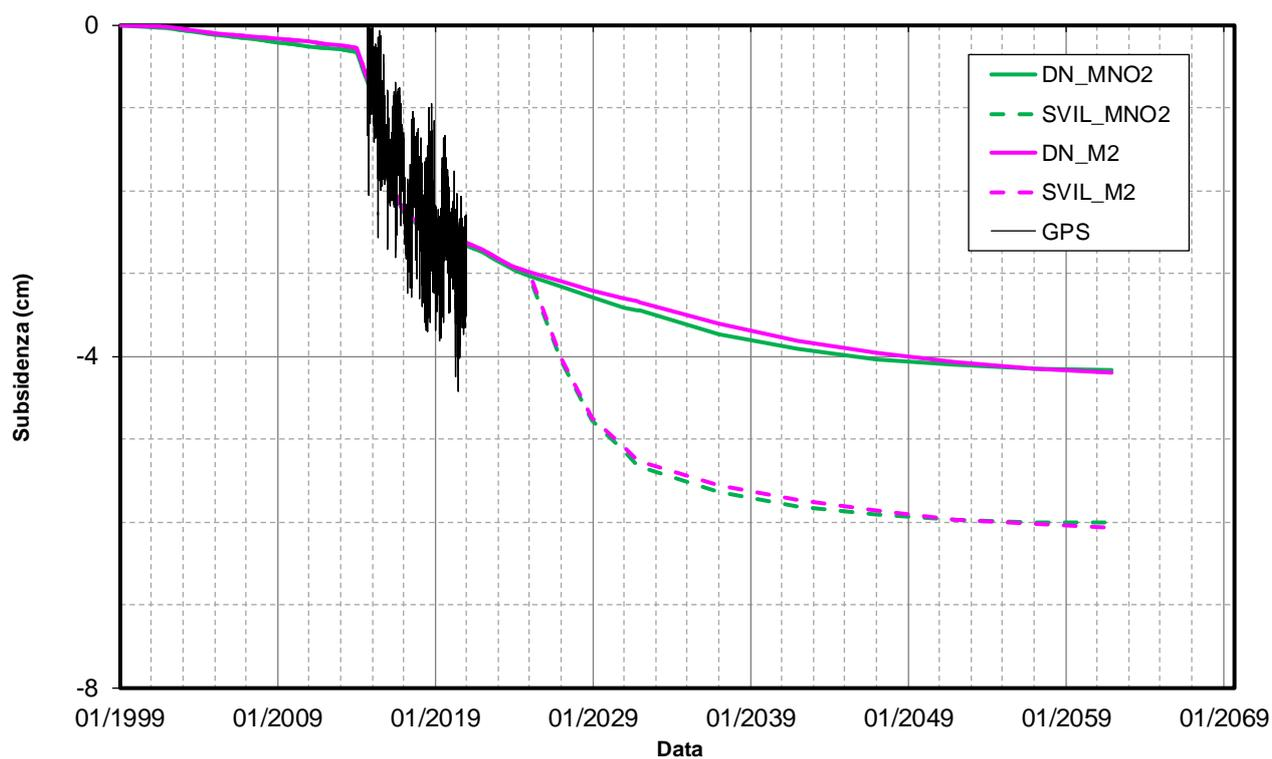
**Figura 7 – Spostamento misurato e calcolato in corrispondenza della stazione CGPS di Fauzia.**
