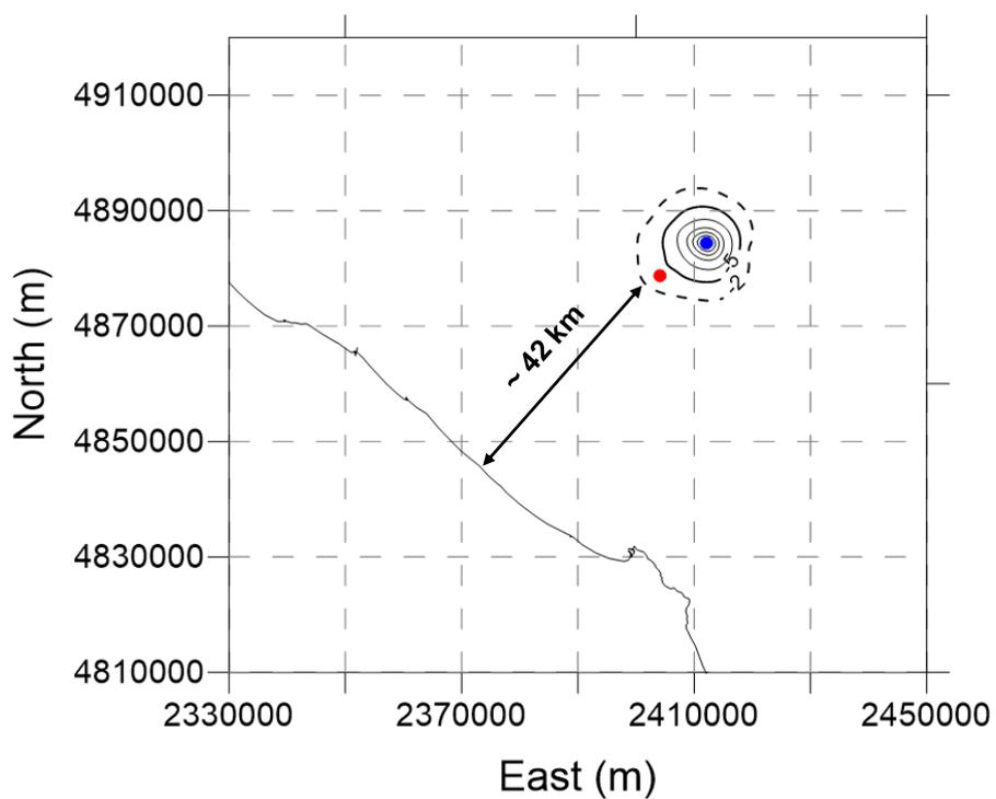
Figura 17 – Curve di iso-subsidenza per lo scenario DN\_M2 a fine simulazione (2062).
