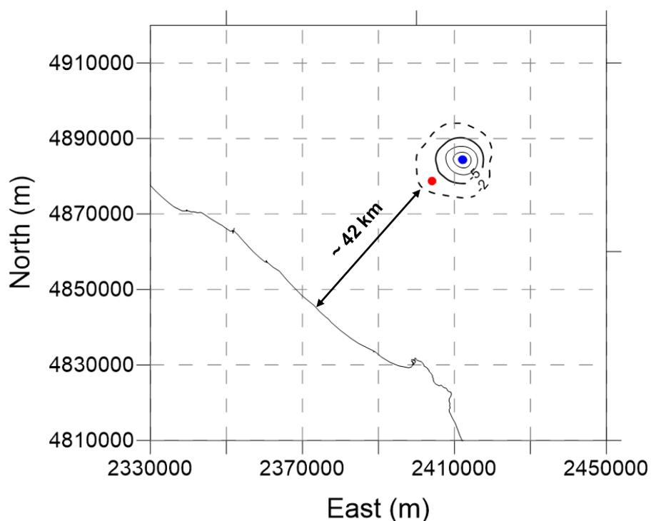
Figura 10 – Curve di iso-subsidenza per lo scenario DN\_MNO2 a fine simulazione (2062).
