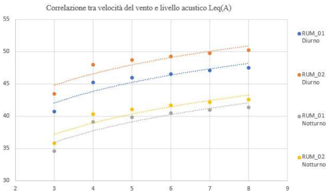
Figura 3-28 Correlazione tra velocità del vento e livello acustico Leq(A) del rumore naturale di fondo (rumore residuo post operam) sulla base dei dati fonometrici rilevati
