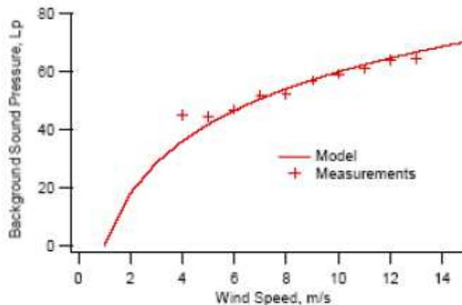
Le misure eseguite sul campo hanno permesso di valutare la correlazione tra intensità di vento e  $L_{eq}(A)$  del rumore ambientale di fondo. In particolare, i due punti scelti ricadono in un territorio omogeneo a carattere prettamente rurale/agricolo ma a diversa altezza rispetto al livello del mare: RUM\_01 è posizionato in cima ad una collina a 525 m s.l.m. mentre RUM\_02 è posizionato al centro di due pendii collinari a 496 m s.l.m.
