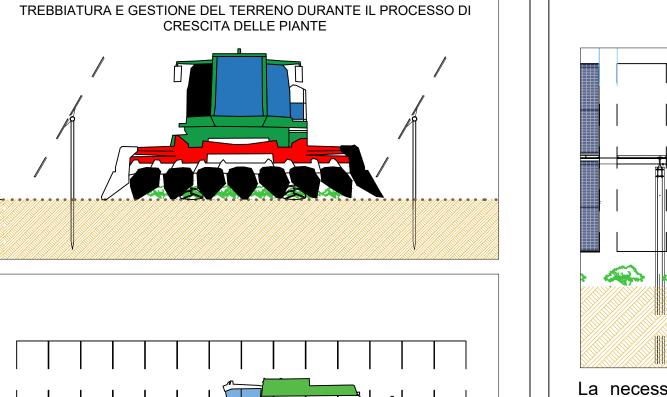
La macchina utilizzata per la trebbiatura potrà essere anche di tipo semovente, con larghezze della barra di trebbiatura sino a 10 mt. L'architettura dell'impianto pertanto consente coltivazione di foraggiere ed erbacee, consentendo altresì l'utilizzo delle ordinarie macchine già impiegate per le coltivazioni a campo aperto, in un regime di completa
