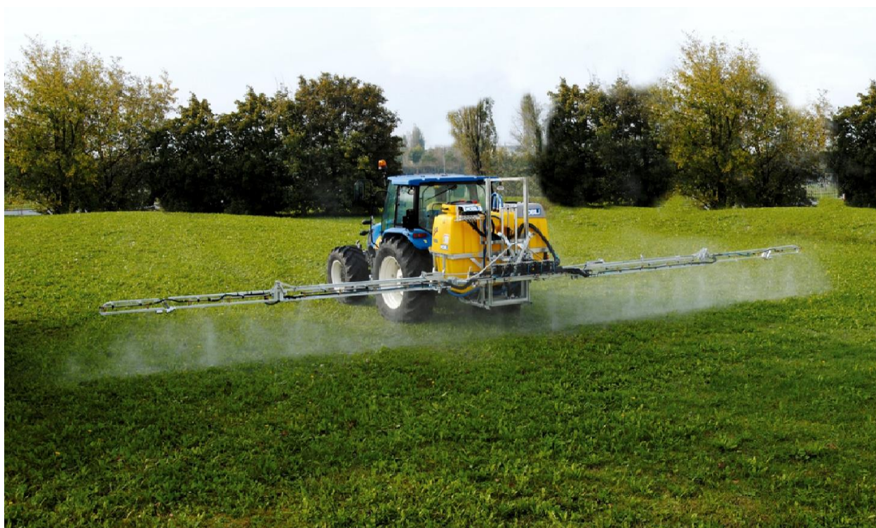
Foto 4 barra irroratrice con ugelli antideriva
