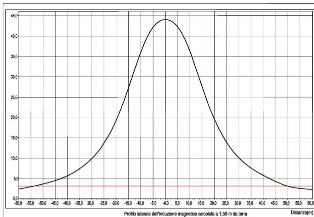
Figura 1: andamento dell'induzione magnetica in una sezione perpendicolare agli assi delle linee, calcolata ad 1,5 m dal suolo nel caso di franco minimo pari a 14,0 m per il sostegno di amarro 380 kV. (in rosso l'obiettivo di qualità pari a 3 μT).
