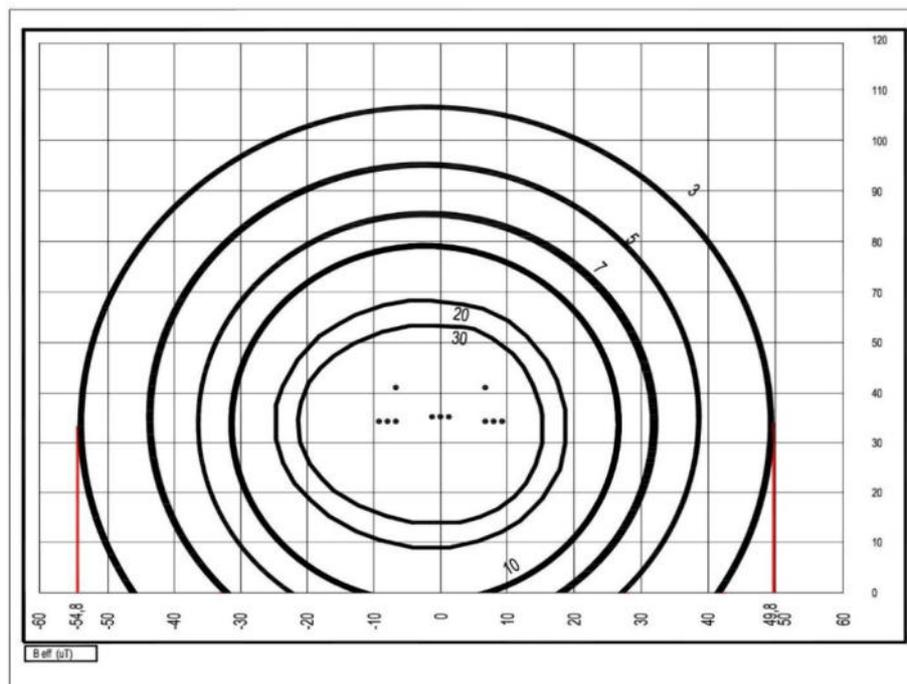
**Figura 3: Curve di isocampo a 3 µT in una sezione perpendicolare all'asse linea per un sostegno in amaro 380 kV. DPA = 54,80m.**
