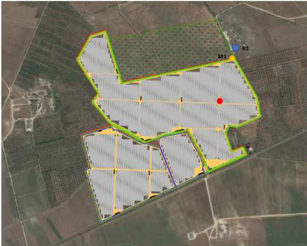
Indicazione dei ricettori (pallini azzurri), delle cabine inverter / trasformazione BT/MT (pallini rossi), dei punti di misurazione di Leq(A) (pallini gialli)
