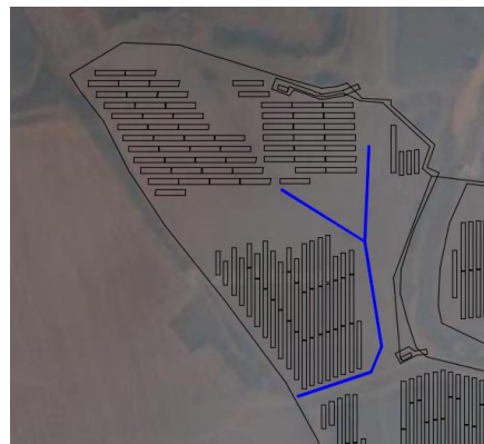
Figura 7-22- Riprofilatura di progetto esterna all'area di impronta dei moduli
