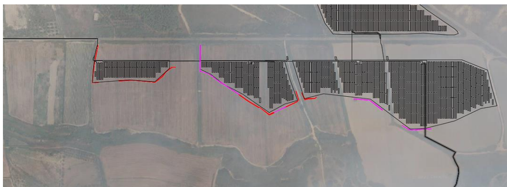
Figura 7-16- Tratti di riprofilatura di terreno; in rosse riprofilature di altezza fino a 1.65 m; in magenta riprofilature di altezza fino ad 1.20 m
