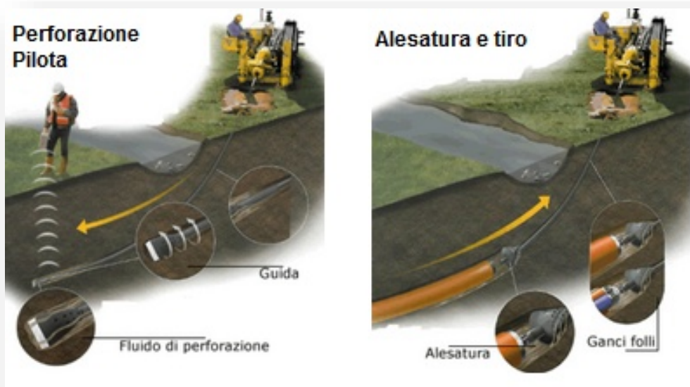
Figura 26- Tecnologia di trivellazione orizzontale controllata (TOC)
