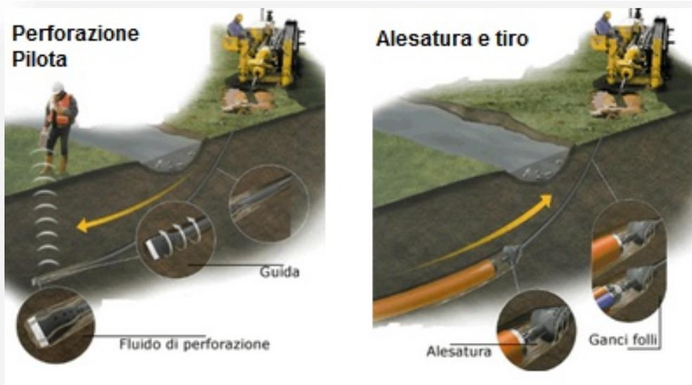
Figura 26- Tecnologia di trivellazione orizzontale controllata (TOC)
