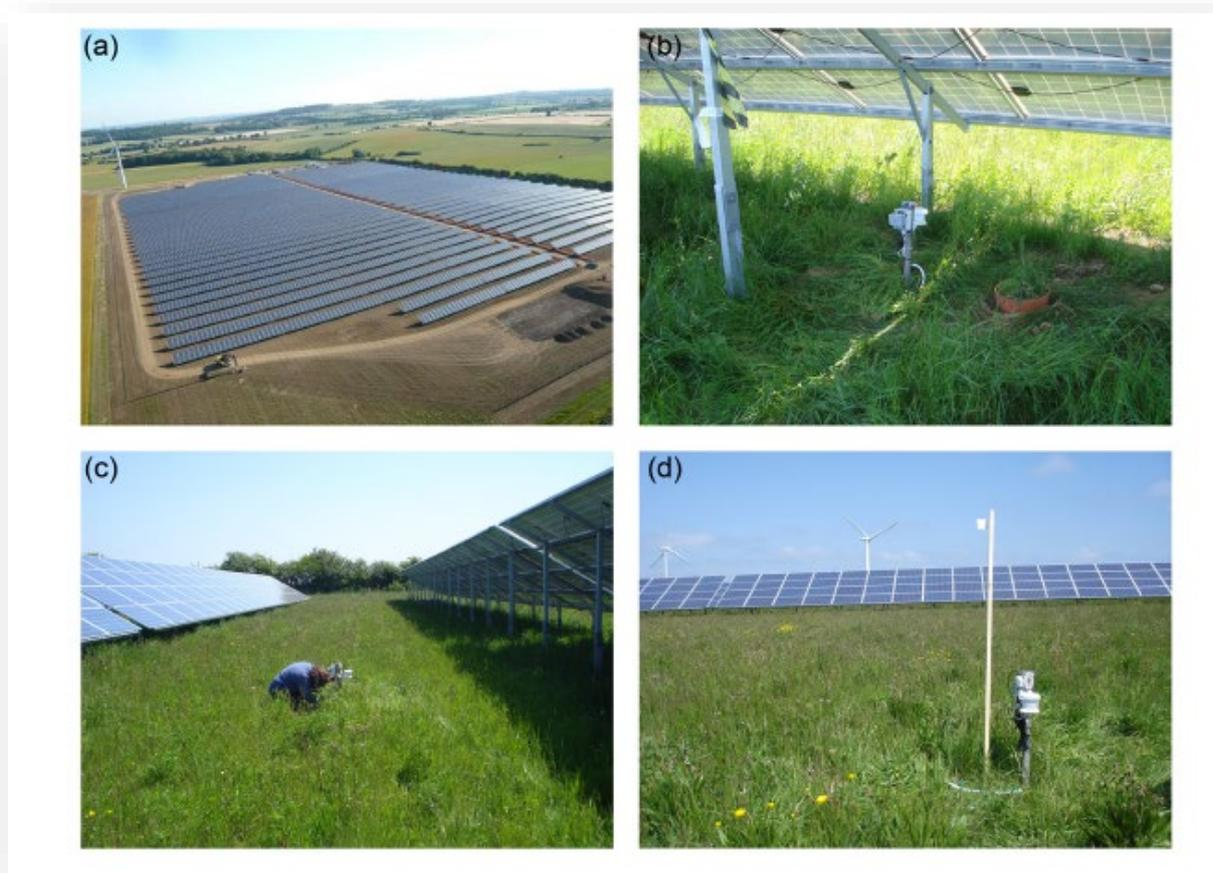
Figura 30- (a) foto aerea del Westmill Solar Park; (b) Under: punto di rilevamento sotto i moduli; (c) Gap: punto di rilevamento tra i filari di moduli; (d) Control: punto di rilevamento esterno
