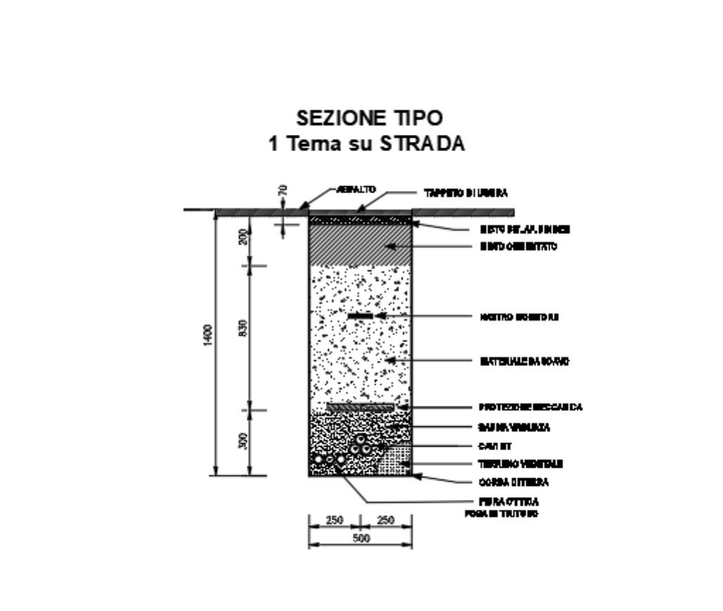
I risultati ottenuti mostrano che, in corrispondenza dell'asse del cavidotto su un punto a quota stradale, corrispondente a tutti i CIRCUITI a singola TERNA di diversa sezione, per posa pari a 1,4 m, vengono raggiunti i valori massimi in un punto di induzione magnetica pari rispettivamente a 2,67  $\mu$ T
