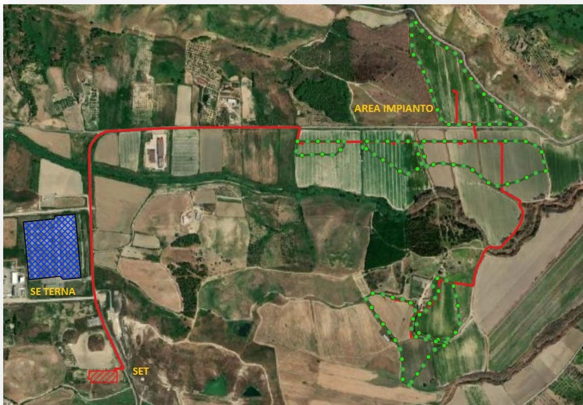
Figura 10- Percorso dell'elettrodotto interrato MT da realizzare (tratto in rosso)
