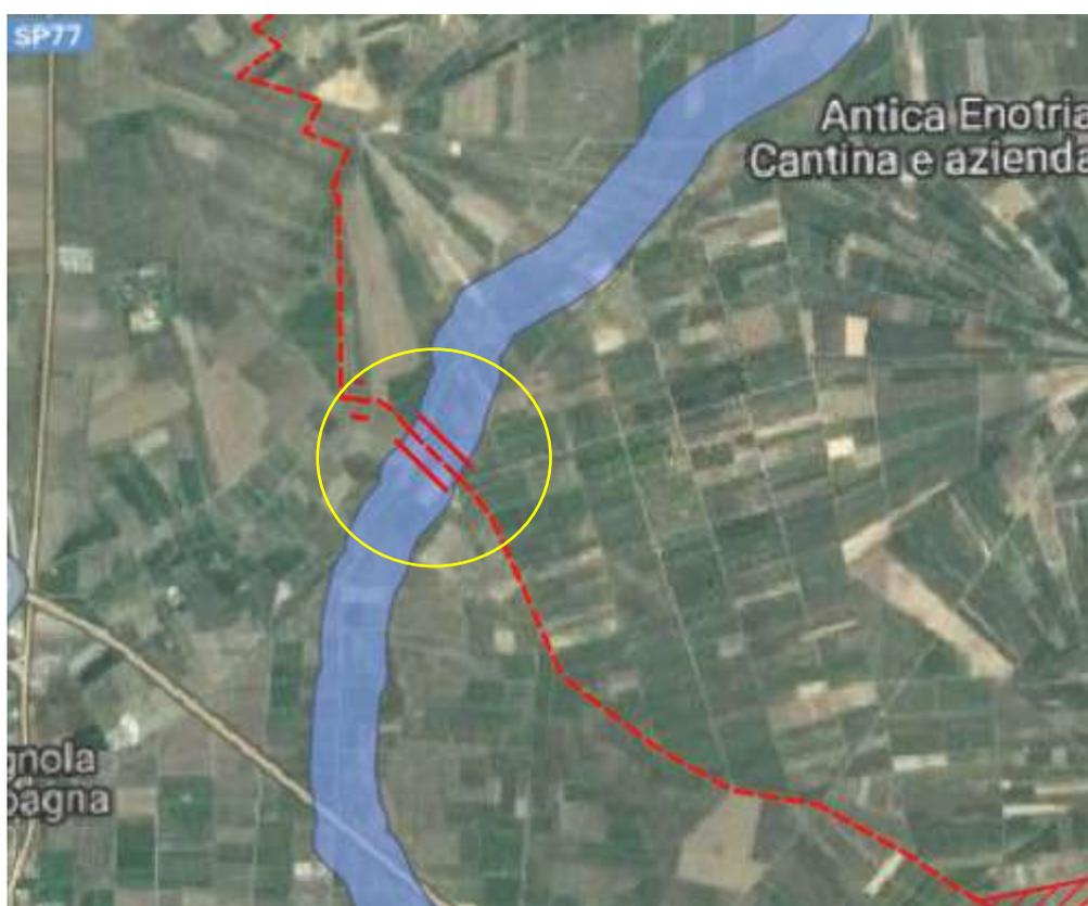
Figura 21 – Particolare interferenza tra cavidotto interrato in MT e componente idrologica del PPTR pugliese
