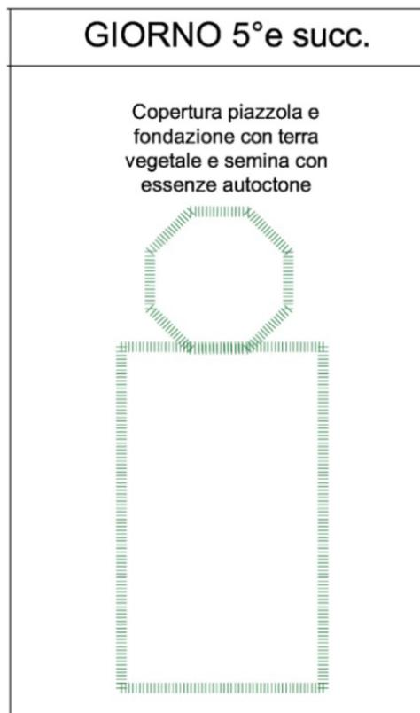
*Figure 3 - Fasi di smontaggio degli aerogeneratori*
