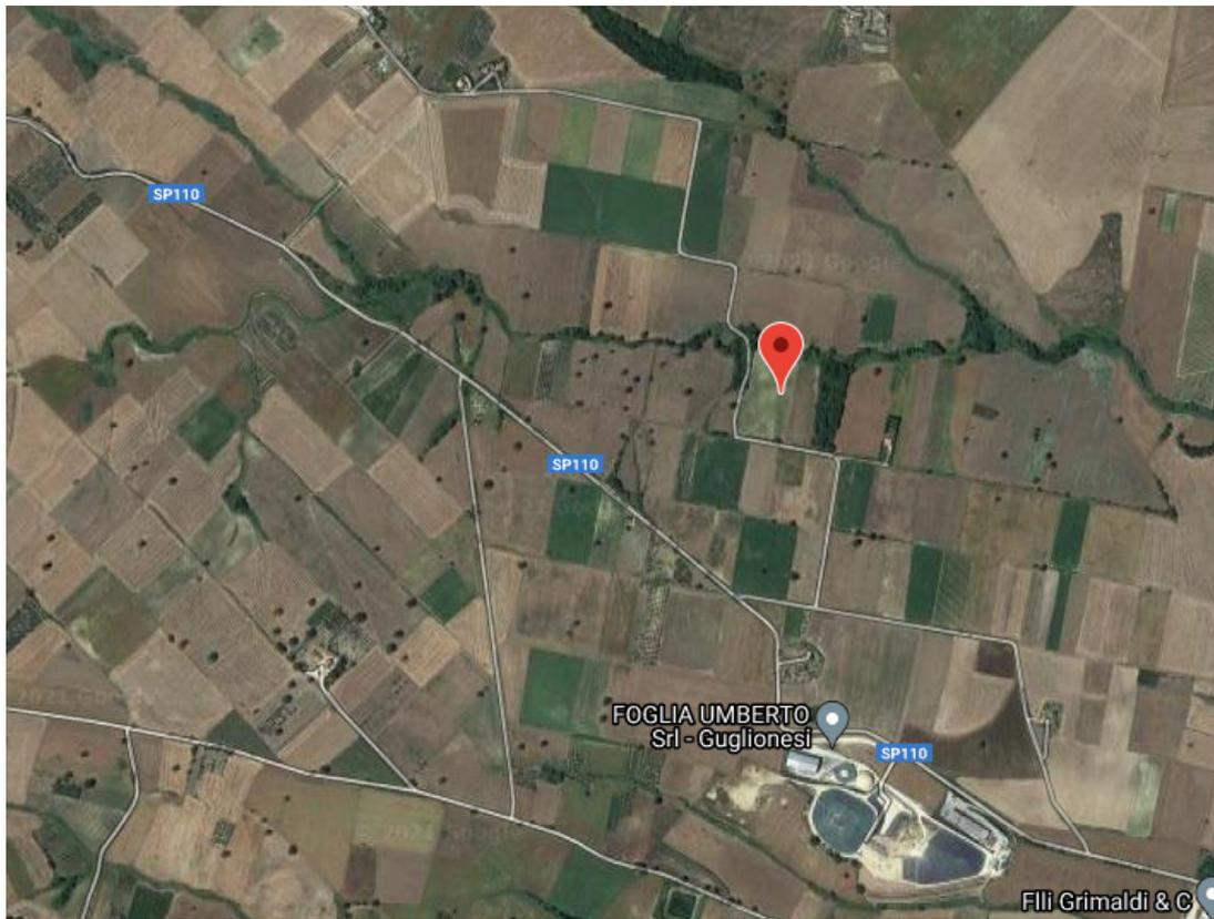
Il comune di Guglionesi (CB) è localizzato in un settore a bassa pericolosità sismica tanto che la nuova mappa prevede per il suo bedrock (o suolo rigido con  $V_s > 800$  m/s) la probabilità di superamento del 10% in 50 anni di un valore convenzionale di accelerazione massima orizzontale ( $a_g$ ) variabile da 0.125 a 0.150 g.
