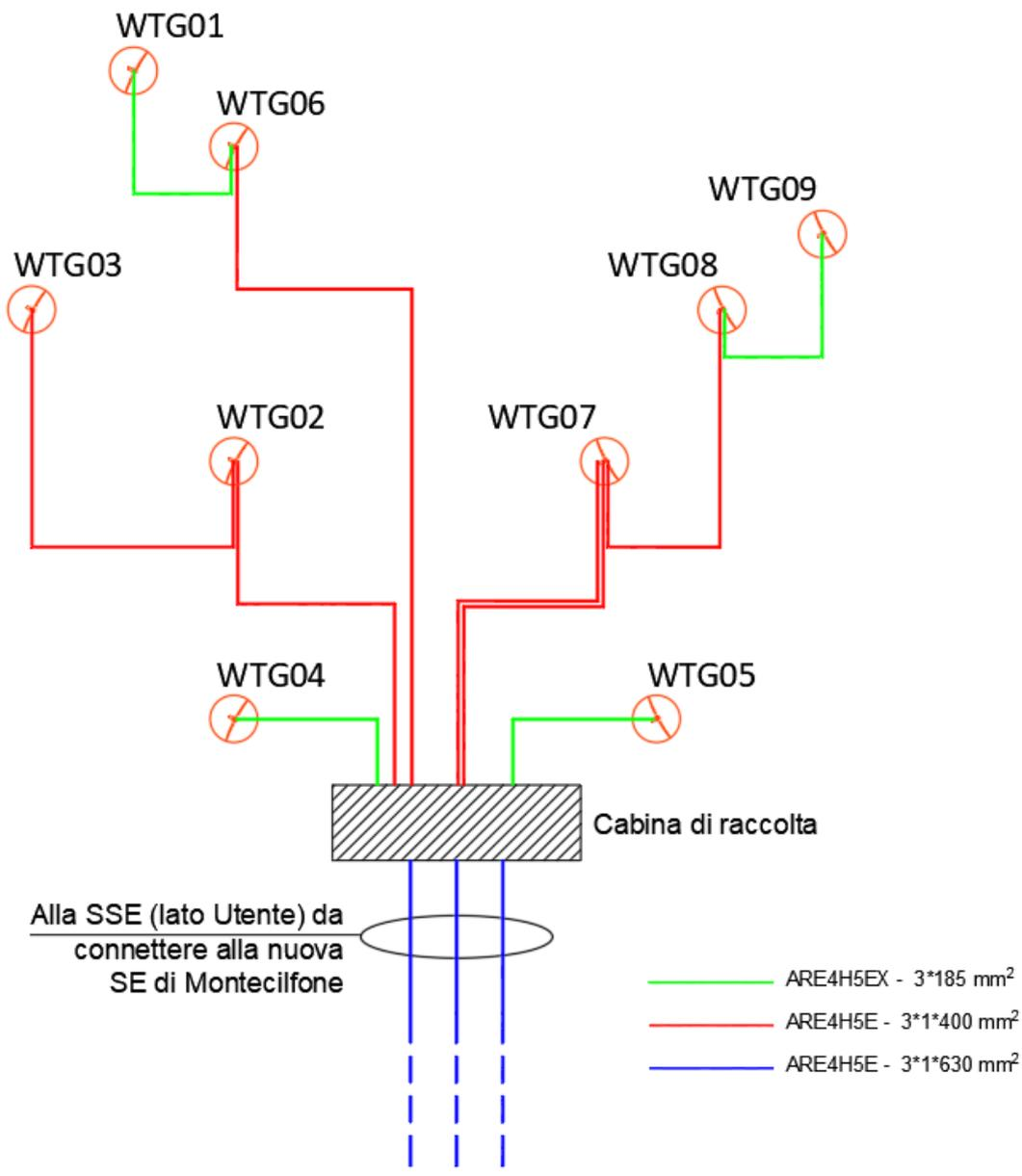
Figura 29- Schema di connessione elettrica dell'impianto eolico in progetto
