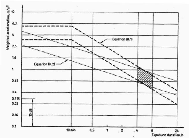
la coppia di curve B.1 (inferiore e superiore) che rispetta il criterio dell'equivalenza dell'energia, con esponente della variabile tempo pari a  $\frac{1}{2}$  :
