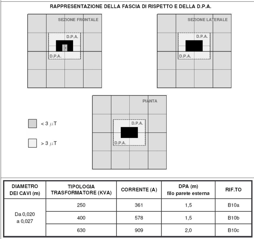
Figura 31 - Scheda B10 delle Linee Guida per l'applicazione dell'Allegato al DM 29.05.08 di Enel Distribuzione SpA
