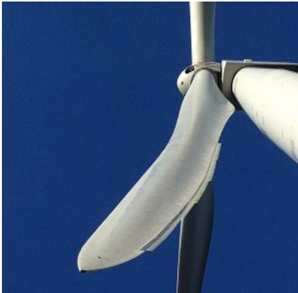
(Controllo di Passo). Le pale sono tipicamente costituite da fibre composite a base di vetroresina rinforzata.
