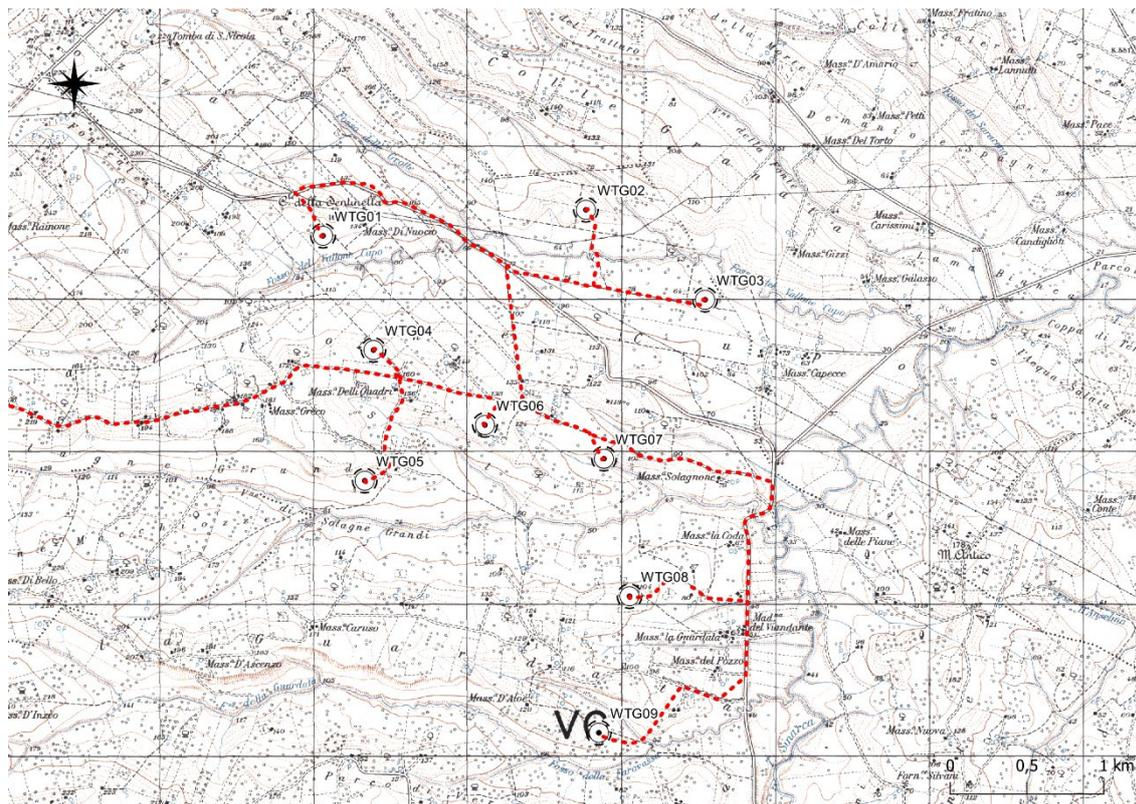
*Figura 25 - layout impianto a n.9 aerogeneratori*
