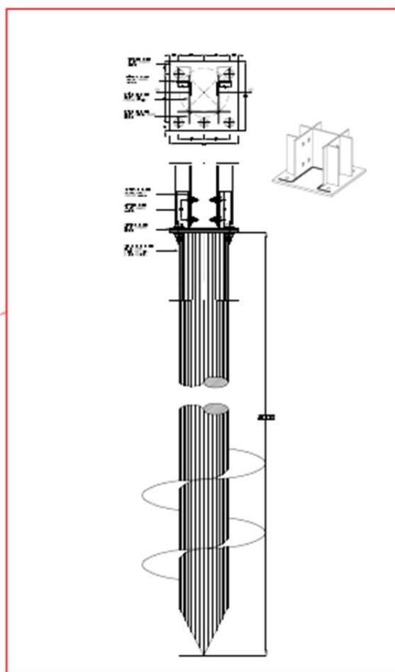
Figura 1. Particolare palo di fondazione in acciaio
