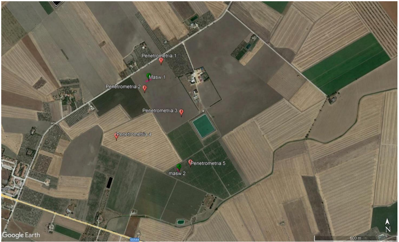
Figura 8: Ubicazioni indagini penetrometriche in sito e profili delle indagini geofisiche
