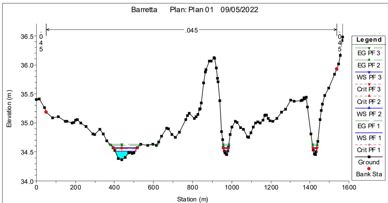
Figura 10 | Sezioni con indicazione del livello idrico massimo cinque centennale
